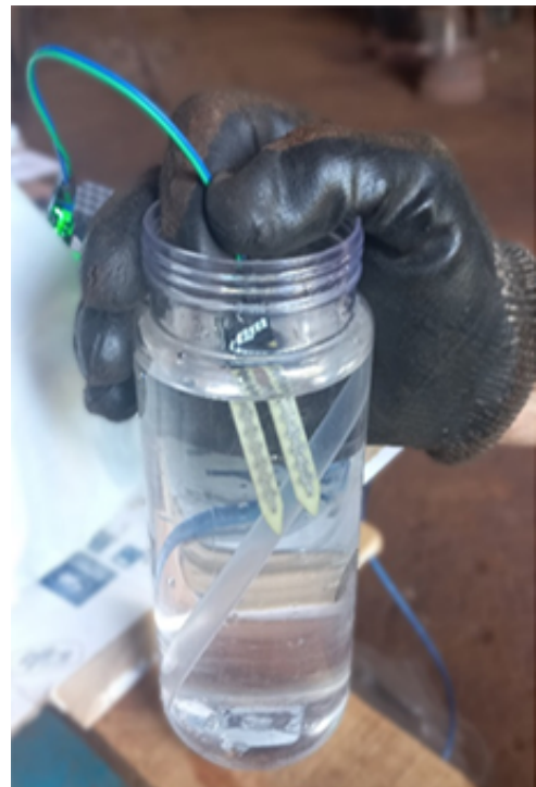
(d) Calibración del Sensor YL-69.
