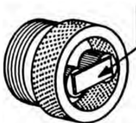
Figura 13. Matriz anular con rodillos (Oberberger y Thek, 2010).
