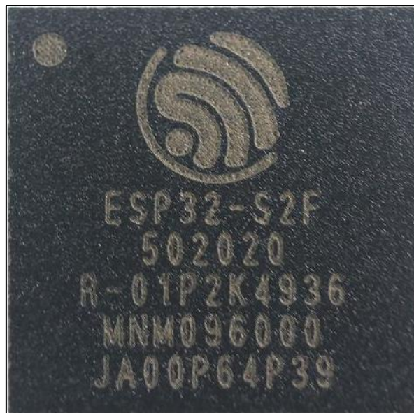
Figura 1: SoC ESP32-S2F (Fuente: ar.mouser.com)
