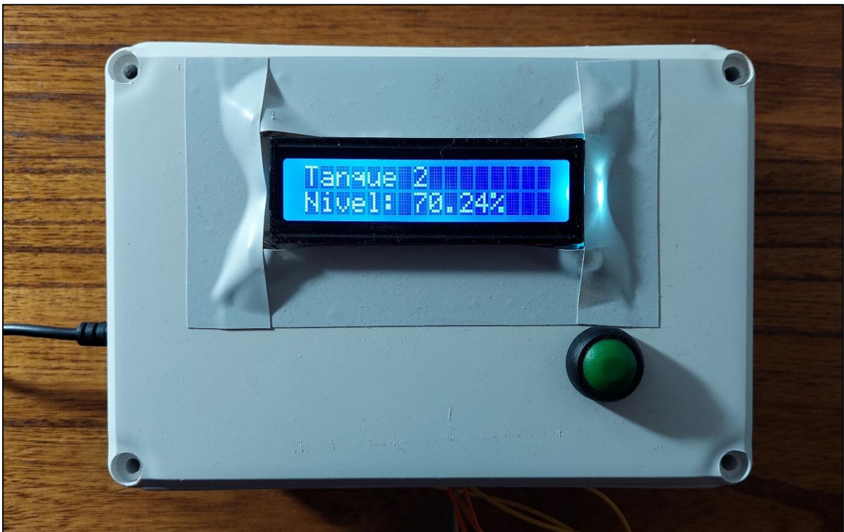
Figura 73: Visualización local del nivel de agua en el tanque 2.
