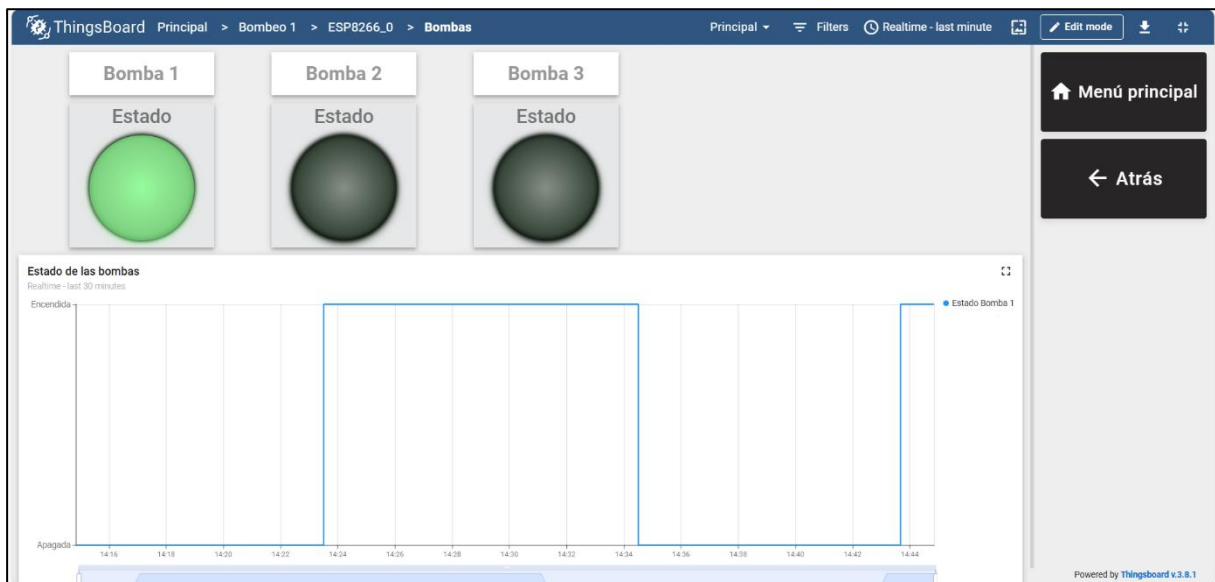
Figura 65: Cuadro de estado para las bombas vinculadas al ESP8266 de la zona "Bombeo 1".
