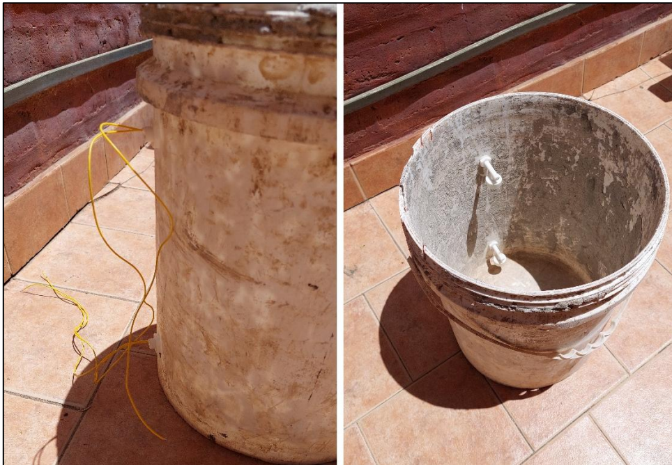
Figura 54: Recipiente de pintura para la simulación del tanque con los sensores flotadores ubicados.
