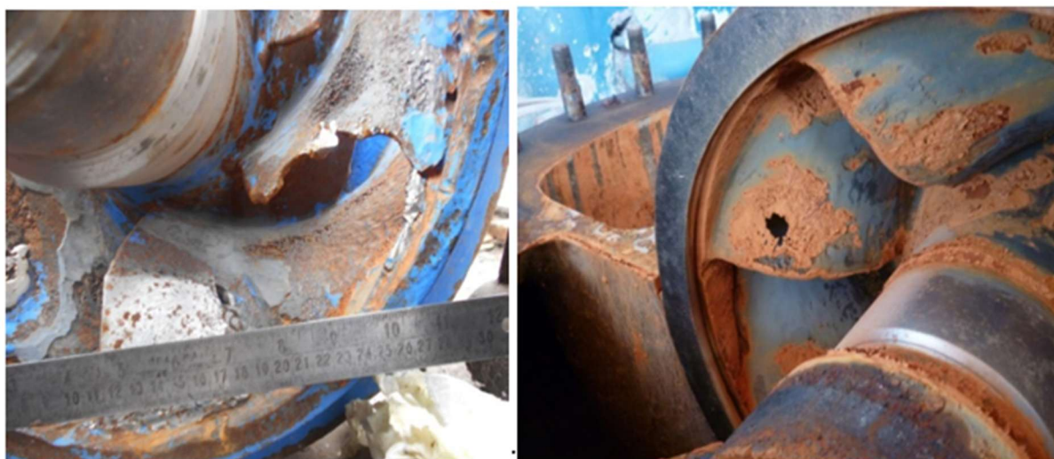
Imagen 2 - Estado de Impulsores luego de la temporada 2016
