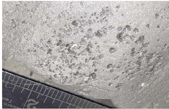
Imagen 32 - Daño por Cavitación en rodete arenado
