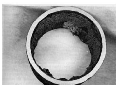
Figura 2.21. Envejecimiento en tuberías (Fox R. W. y McDonald A. T., 1992).
