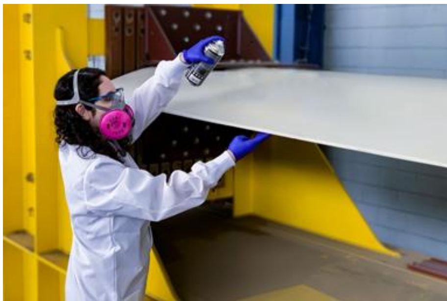
Figura 10: Aplicación de recubrimiento sobre placa metálica (Elemental Coatings)
