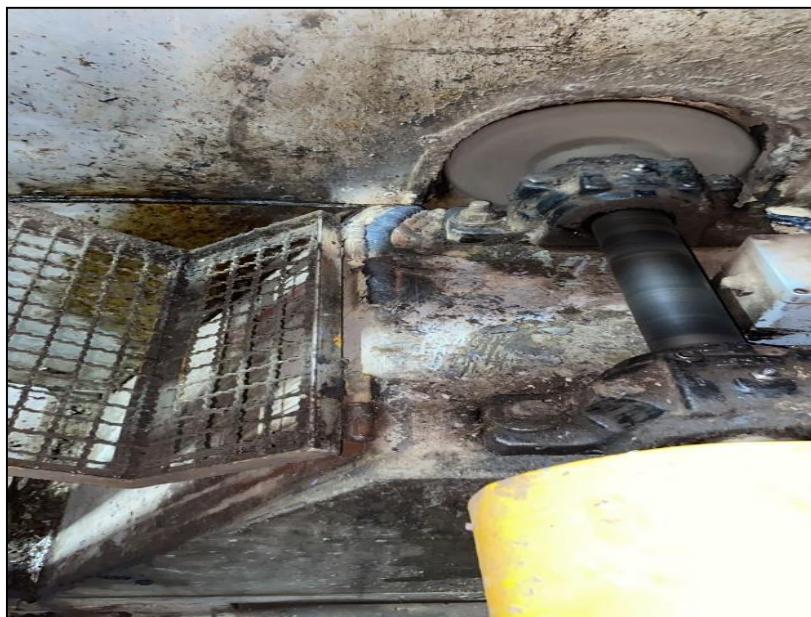
Figura 78 : Estado de base de chumacera, rodamiento y eje (Desarrollo propio)
