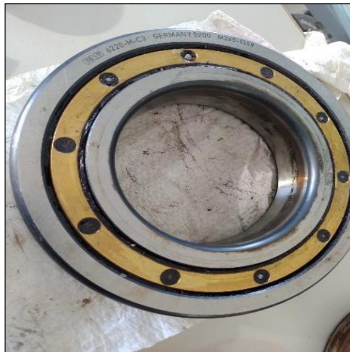
Figura 91 : Rodamiento deteriorado 6220 M/C3 (Desarrollo propio)
