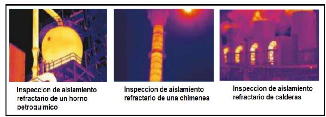
Figura 19 : Inspecciones de aislamiento (Fenercom.com)
