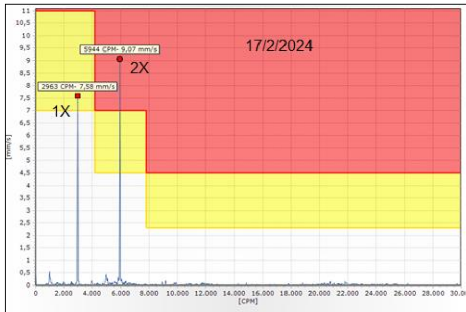
Figura 69 : Espectro de velocidad punto 3V (Desarrollo propio)
