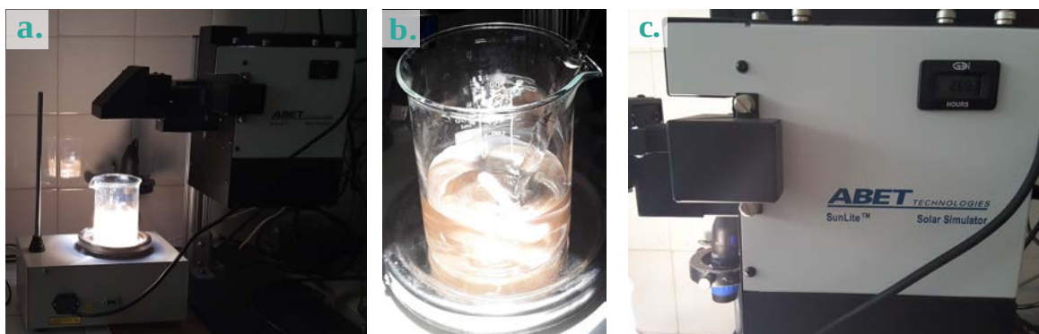
Figura 49. Sistema de reacción Foto-Fenton.
