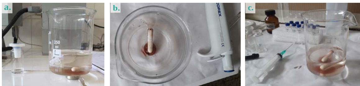
Figura 53. (a) Separación magnética breve para el muestreo; (b) Separación magnética para recuperación el sólido y extracción del sobrenadante; (c) Lavado magnético de la FePILC ya utilizada.
