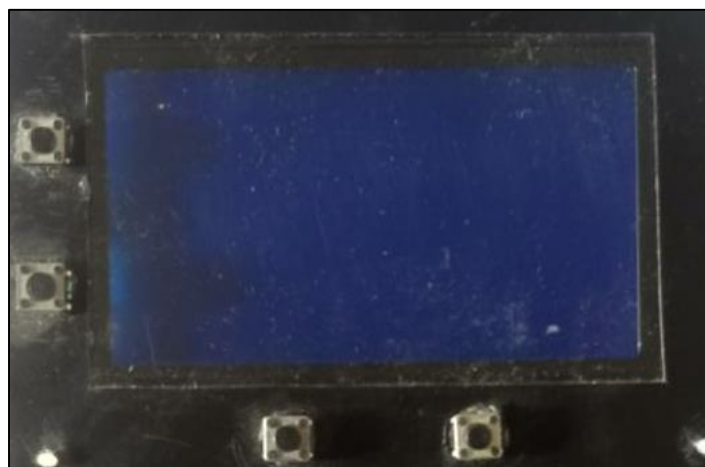
Fig. 19 – Detalle de la pantalla y pulsadores de navegación del primer prototipo.
