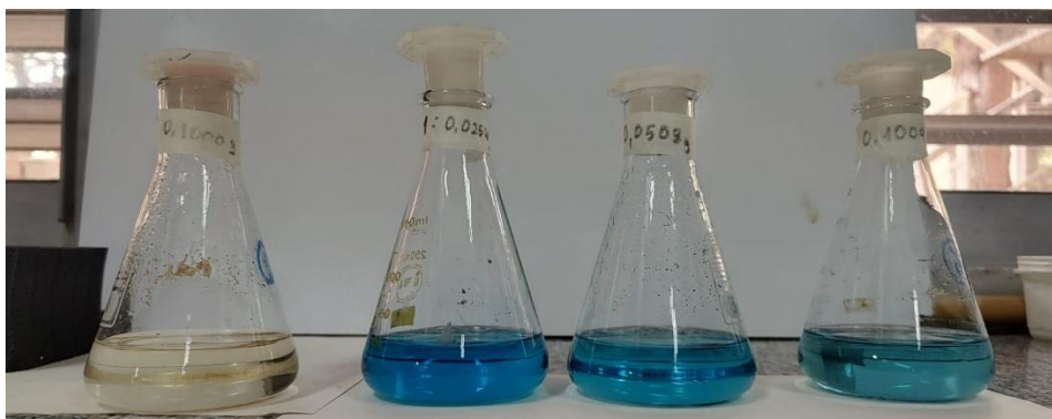
Figura 23. Blanco y soluciones de azul de metileno con cáscaras de manzana disecadas como bioadsorbente en reposo
