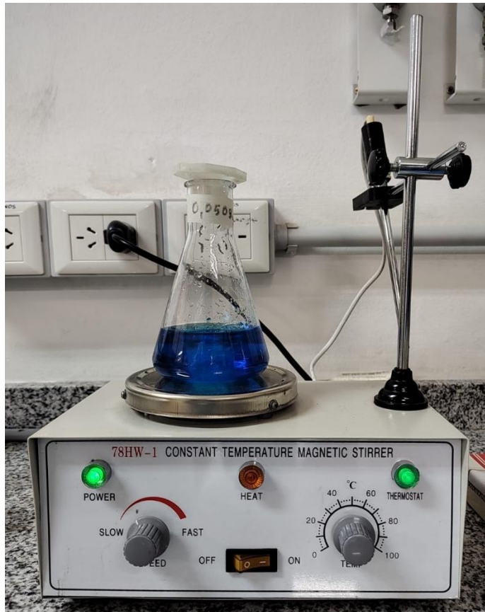
Figura 22. Azul de metileno 10 ppm con cáscara de manzana disecada en el agitador magnético
