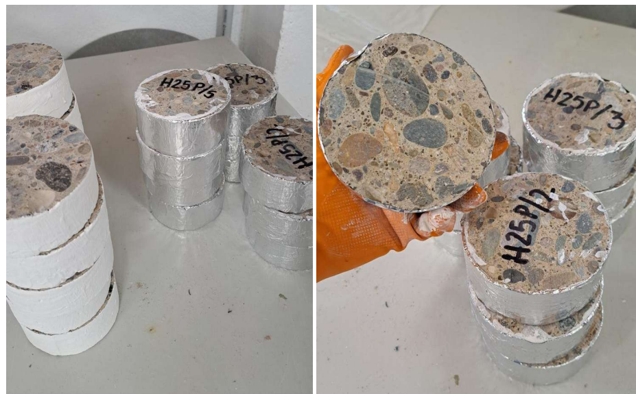
Figura 13. Procedimiento de impermeabilización lateral de doble barrera. (a) Aplicación de primera capa de pintura epoxi y segunda capa de cinta de aluminio. (b) Probetas con sistema de impermeabilización completo, listas para el acondicionamiento previo al ensayo.
