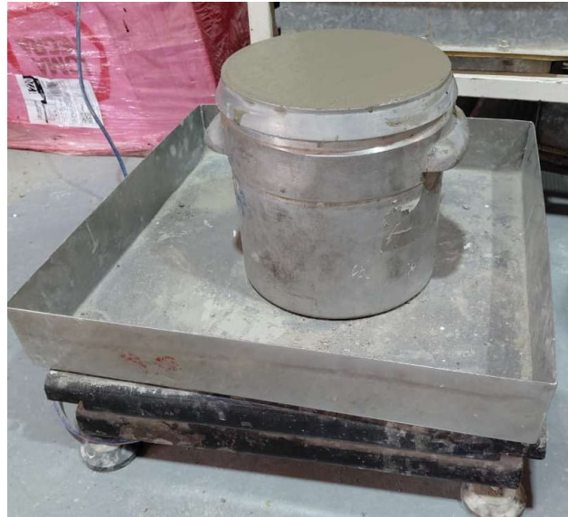
Figura 8. Determinación del peso unitario por unidad de volumen (PUV) según norma IRAM 1562.
