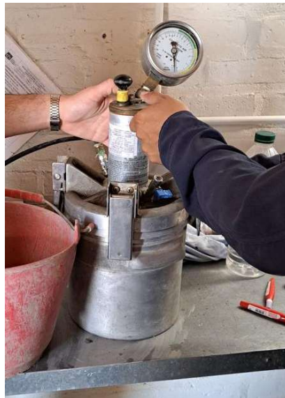
Figura 7. Determinación del contenido de aire conforme norma ASTM C231.
