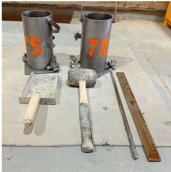
Figura 2. Equipamiento utilizado para la elaboración de probetas.
