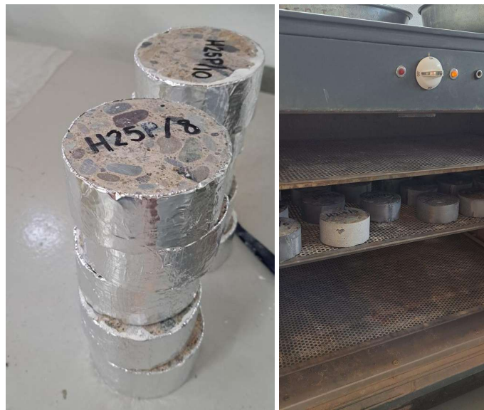
Figura 12. Ensayo de absorción y densidad conforme norma ASTM C642. (a) Probetas previas al ensayo. (b) Probetas en el horno durante el proceso de secado.
