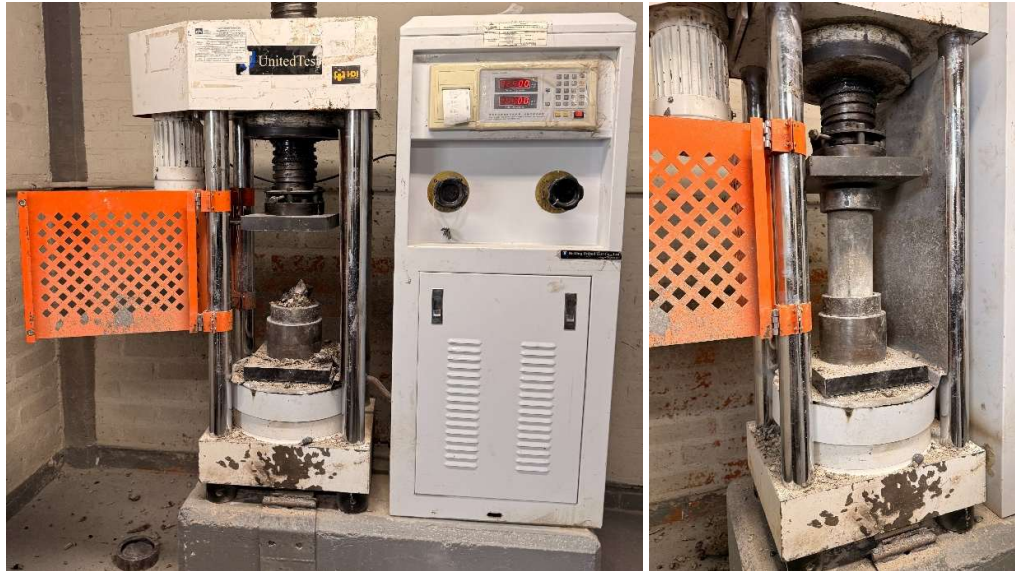
Figura 9. Equipamiento empleado para el ensayo de Resistencia a la Compresión Simple. (a) Prensa hidráulica. (b) Probeta posicionada previa al inicio del ensayo.
