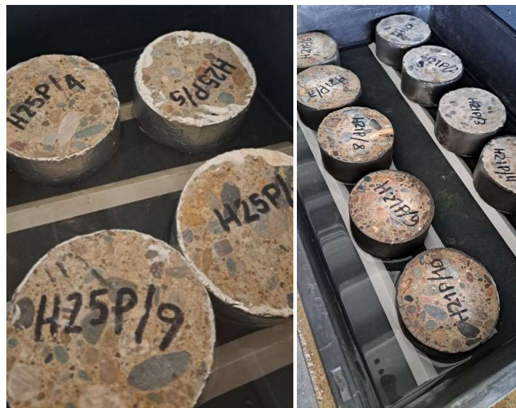
Figura 11. Ensayo de velocidad de succión capilar (VSC) conforme norma IRAM 1871. (a) Probetas impermeabilizadas previas al ensayo. (b) Probetas durante la ejecución del ensayo, en contacto con la lámina de agua.
