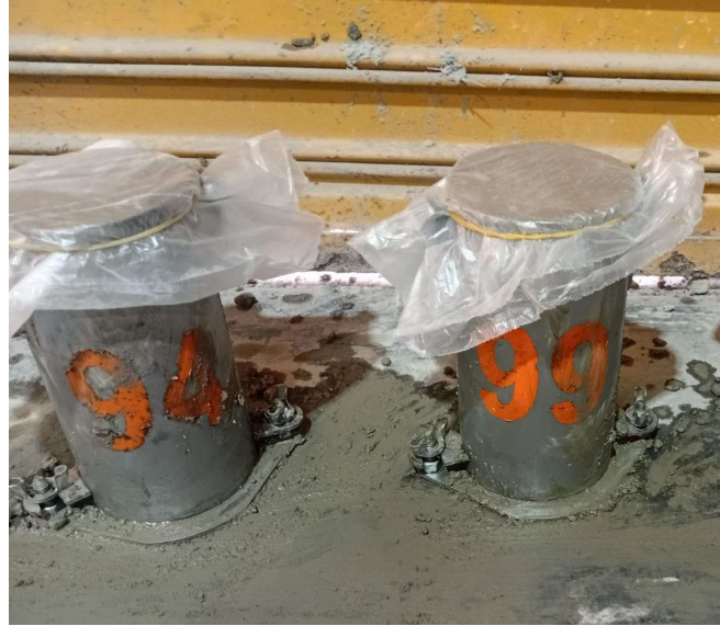
Figura 3. Conservación inicial de probetas tras el moldeo.
