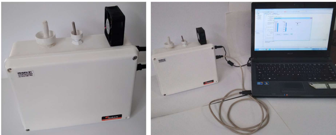
Figura 3.15: Dispositivo medidor de humedad preparado para inicio de mediciones.
