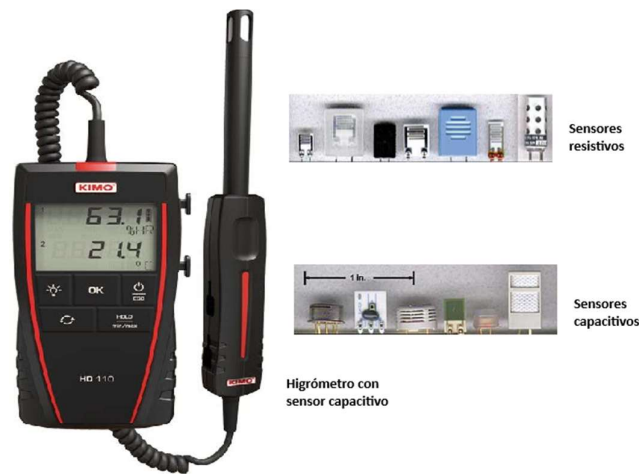
Figura 2.2: Higrómetro e imágenes de sensores. Fuente: Hoja de datos del fabricante Kimo y Roveti D. (2001)
