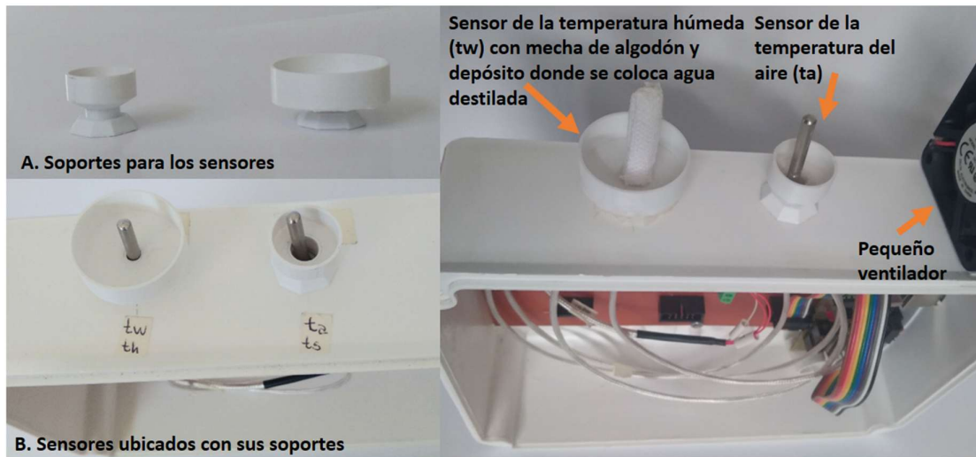
Figura 3.14: Muestra del dispositivo medidor de humedad, los soportes utilizados (A), la distribución (B) y la disposición final (lado derecho).
