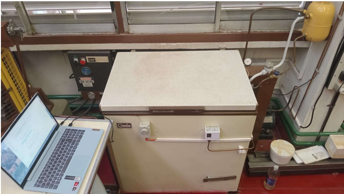
Figura 4.4.1.1. Disposición de equipo de trabajo para las pruebas en frío, llevadas a cabo en el congelador del Laboratorio de Propiedades Mecánicas.
