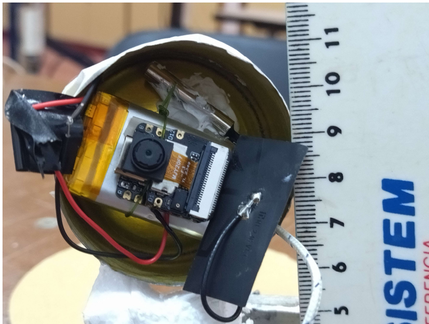
Figura 4.4.1.2. Disposición de cámara y batería espalda contra espalda, en el interior del volumen usado para simular el contrapeso, junto con su antena correspondiente y sonda de medición de temperatura.
