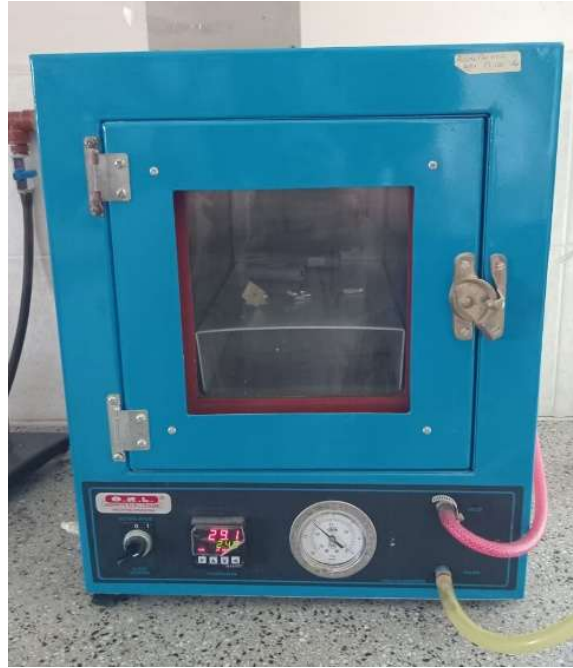
Figura 4.4.3. Cámara de vacío realizando el ensayo, con las baterías y placa cámara en su interior.
