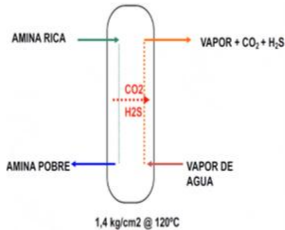
Figura 2.1.2.2.4 Remoción de gases ácidos de la solución de aminas.
