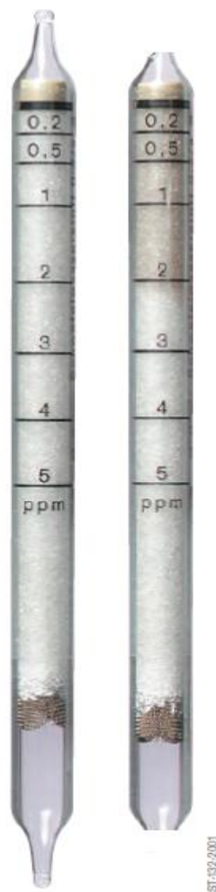
Figura 3.2.2.1.1 Ampollas Dräger para medición H_2S en rango 0,2 a 5 ppm.
