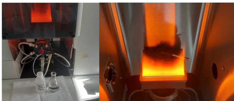
Figura 40: Espectrofotómetro de llama de aire-acetileno utilizado en las mediciones.
