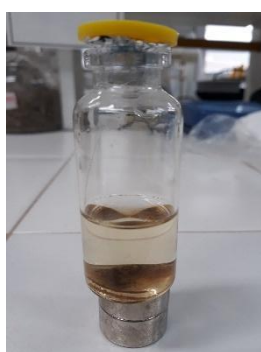
Figura 37: Separación de \text{Fe}_3\text{O}_4\text{-PF} con imán de Neodimio.
