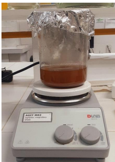
Figura 18: Sistema de extracción utilizado para la síntesis de Fe_3O_4 -PF.
