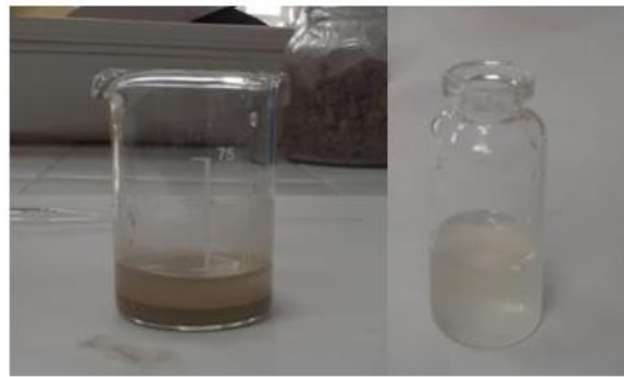
Figura 36: Sistema sólido/líquido (izquierda) y sobrenadante (derecha) del ensayo de lixiviación.
