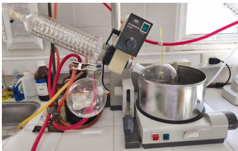
Figura 19: Rotovapor utilizado en el proceso de concentración de polifenoles.
