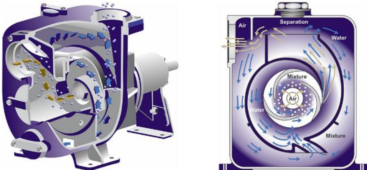
Diagrama interior de una Bomba Autocebante.
