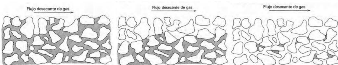
Figura I-4 Distribución de la humedad en un lecho de un sólido durante el proceso de secado. (Adaptado de Foust y col., 2006).
