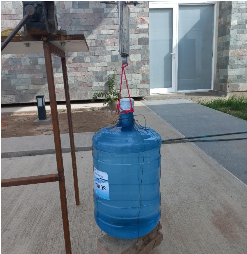
Figura 4.32: Freno activado por la fuerza ejercida por el peso del agua más los ladrillos.
