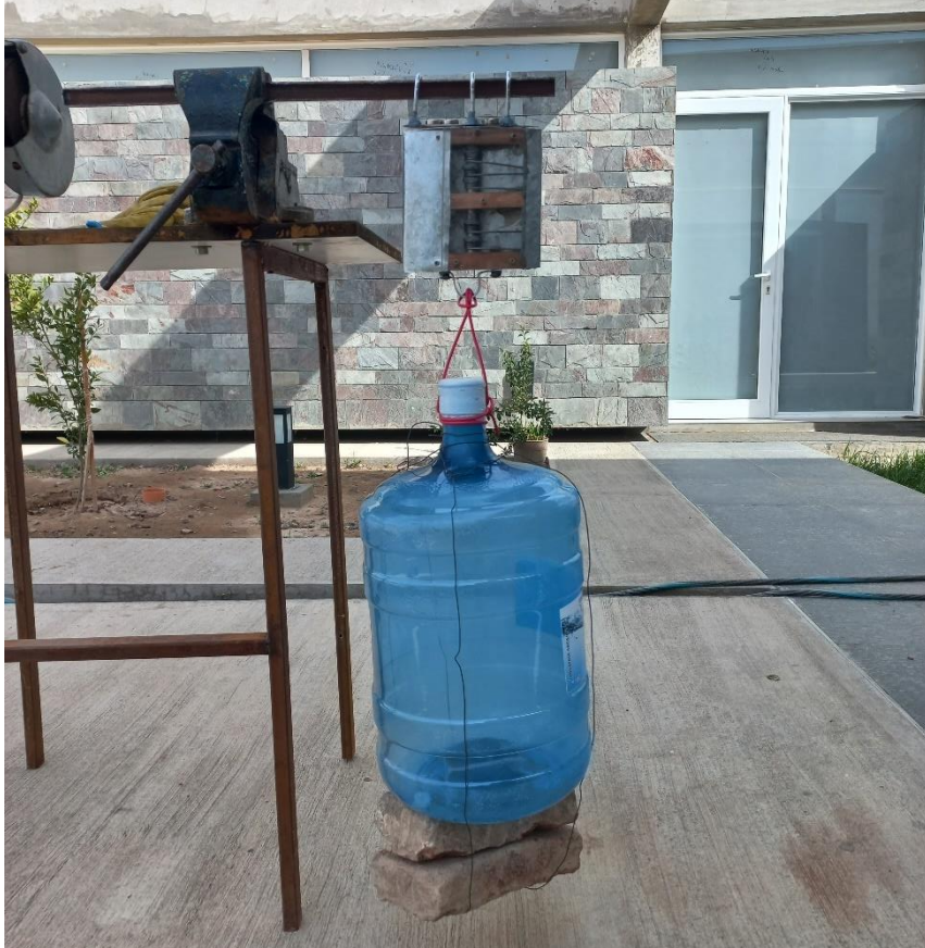
Figura 4.30: Montaje del bidón y los ladrillos que simularan la fuerza dinámica de despliegue.
