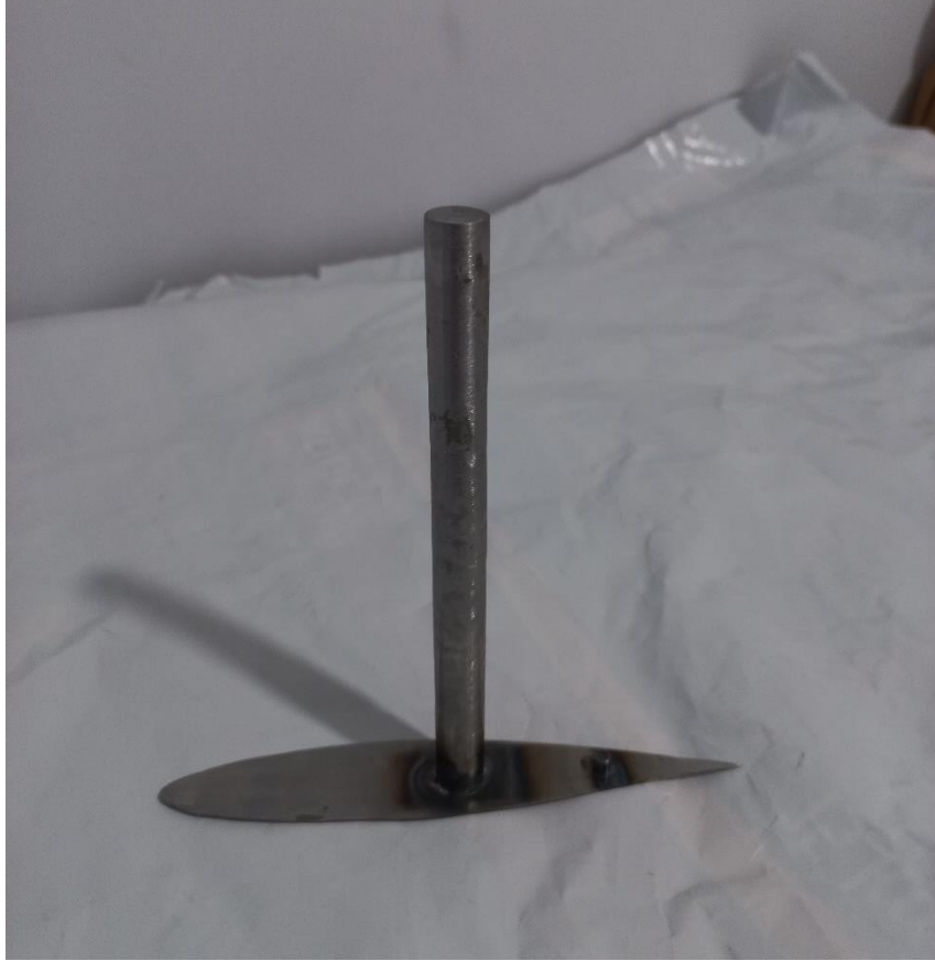
Figura C-2: Tapa de la Pala con los ejes principal y secundarios soldados.
