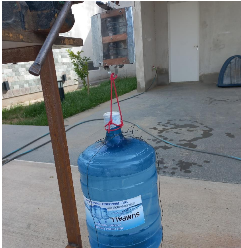
Figura 4.33: Freno activado por la fuerza ejercida por el peso del agua más los ladrillos vista de perspectiva diferente a la Figura 4.22.
