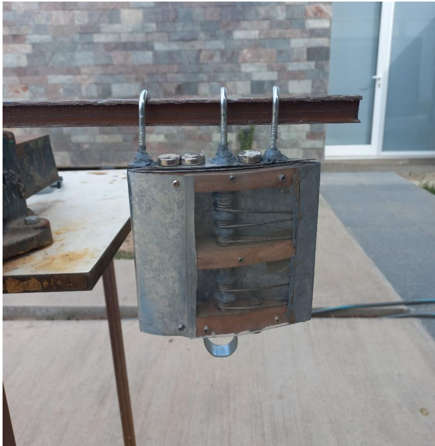
Figura 4.29: Prototipo del freno aerodinámico en donde se pueden observar los imanes en la parte superior del freno y los resortes dentro del cuerpo del freno; los ganchos en la parte superior y la argolla de la parte inferior no son parte del diseño del freno, fueron agregados para realizar el ensayo.
