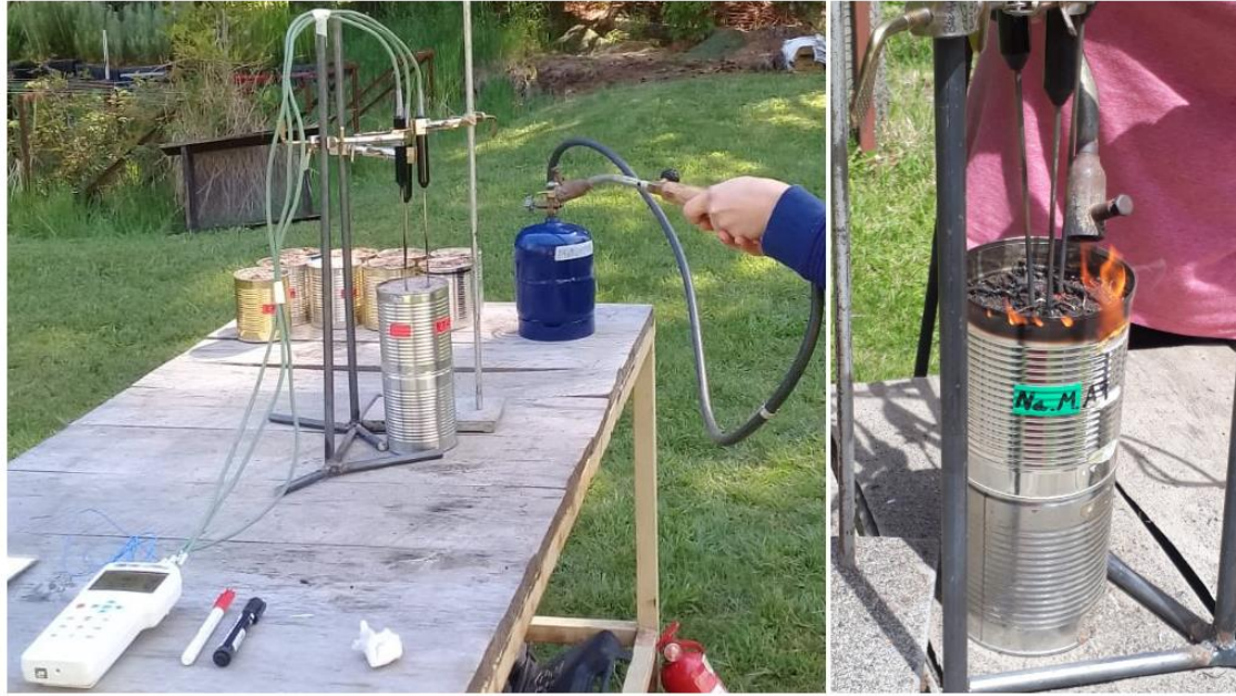
Figura 2.3. Dispositivo utilizado para realizar las quemas experimentales de los suelos. El fuego se suministró mediante un soplete desde la superficie, mientras que las termocuplas conectadas al datalogger y ubicadas en superficie, a 2 cm y a 4 cm de profundidad del suelo registraron las temperaturas durante la quema y luego de la aplicación de las llamas.
