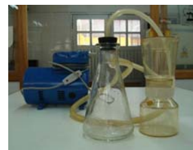
Figura 6. Sistema de filtrado.
