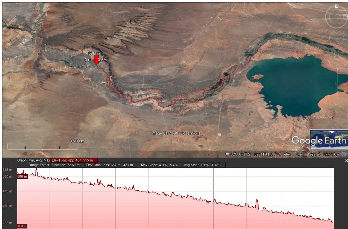
Figura 7.4.11: Cota de inicio del tramo, extensión y desnivel sobre el río Neuquén, desde la estación de medición de caudales Paso de Indios hasta la estación de medición Portezuelo (elaboración propia; Fuente: Google Earth).
