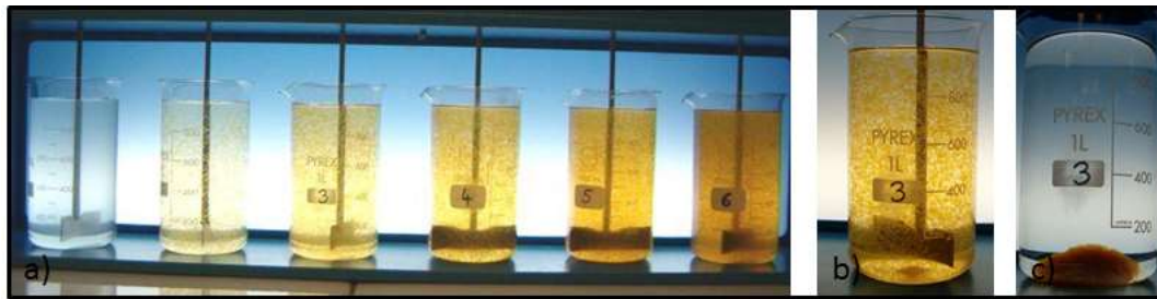
Figura Nº 10: a) EJEMPLO DE UN ENSAYO DE JARRAS b) FASE DE FLOCULACIÓN CON DOSIS ÓPTIMA c) FASE DE DECANTACIÓN CON DOSIS ÓPTIMA. FUENTE: QUÍM. SILVANA QUIJANDRÍA CASANOVA.
