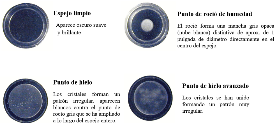
Figura 4.4: ‘Distintos tipos de visualizaciones del espejo cuando se mide el punto de rocío al agua’.
