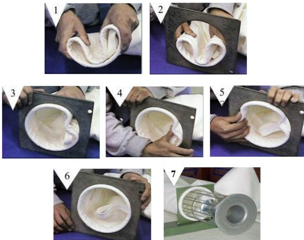
Figura 15: Secuencia de montaje de manga con fijación tipo *Snap Band* (VENTEC, 1999).
