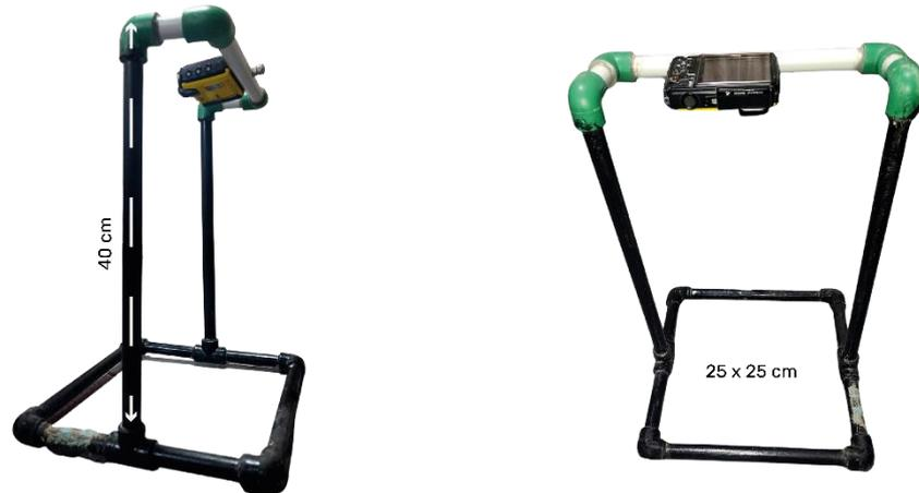
**Figura 3.** Fotocadrante creado con tubos de PVC de 16 mm. Flecha blanca punteada: 40cm.
