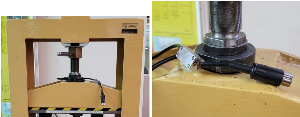
Figura 5.94. Sistema de medición fuera de funcionamiento de la máquina de fatiga.
