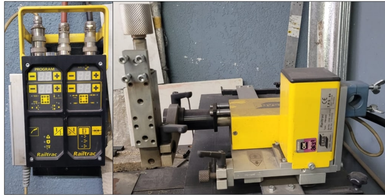
Figura 4.3. Railtrac utilizado para automatizar los cortes por plasma y oxicorte.
