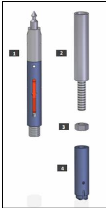
Figura 31. Elementos del conjunto del tapón de perforación del BHA de Wireline Coring. Fuente: Manual CRASA.
