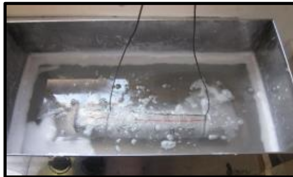
Figura 70. Testigo corona sumergido en parafina.
