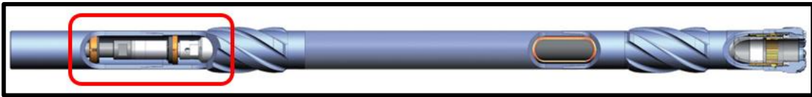
Figura 2. Sección o cabeza superior ( Tope Head ) del BHA de Coring Convencional. Fuente: Manual de CorPro .
