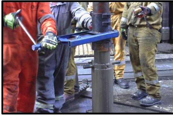
Figura 39. Corte del testigo dentro de la tubería en boca de pozo.
