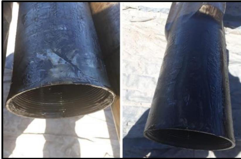
Figura 64. Uniones de las herramientas recuperadas después de la pesca.
