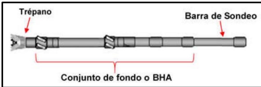
Figura 76: Componentes de la sarta de perforación. Fuente: Bejar Pinochet J.A., Obreque H.M., 2020, Proyecto Integrador Profesional “Aplicación del método de perforación MPD en la Cuenca Neuquina”, Universidad Nacional del Comahue.
