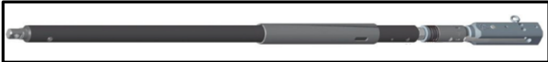
Figura 34. Overshot del cabezal del tubo interno y del conjunto del tapón de perforación del BHA de Wireline Coring. Fuente: Manual CRASA.
