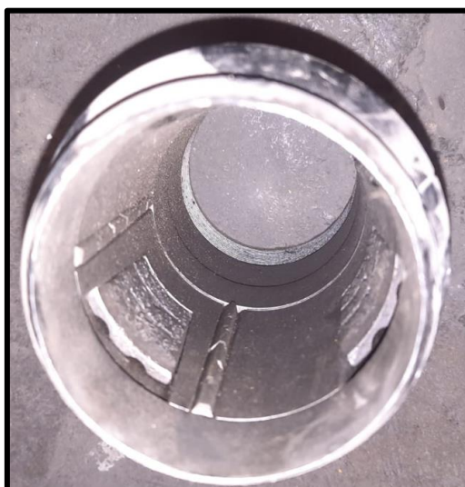
Figura 26. Core Catcher Orientador con vista de sus cuchillas y lengüetas. Fuente: Elaboración propia.
