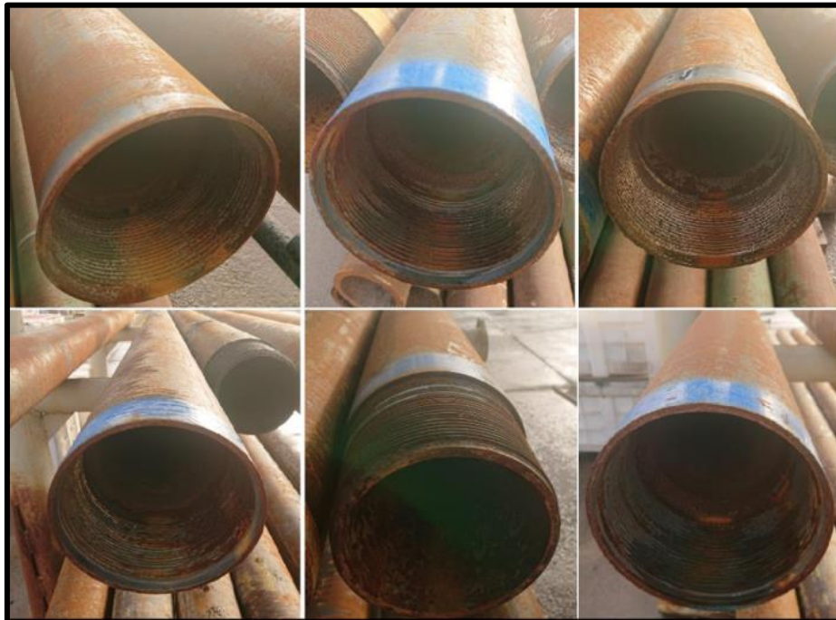
Figura 65. Conexiones Pin y Box de los tubos externos recuperados después de la pesca. Fuente: Brindadas por CRASA.
