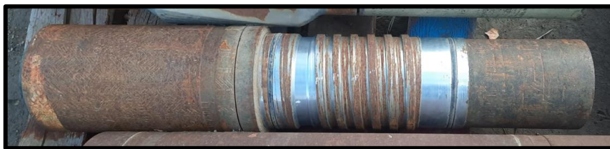
Figura 3. Unión de seguridad externa del BHA de Coring Convencional. Fuente: Elaboración propia .
