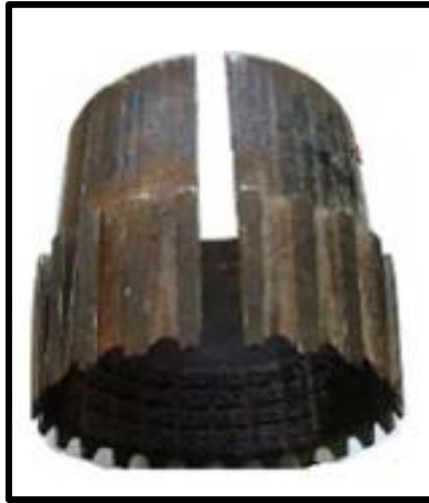
Figura 18. Core Catcher Convencional o colector primavera. Fuente: Brindada por CRASA.
