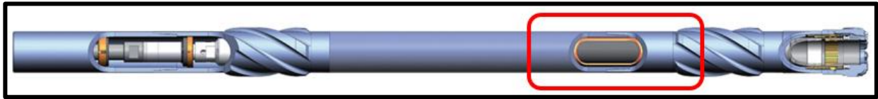
Figura 6. Partes de la sección media del modelo TSS del BHA de Coring Convencional. Fuente: Manual CorPro.
