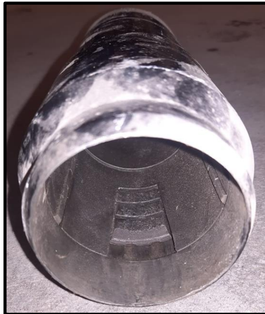
Figura 27. Core Catcher Orientador con posición de las lengüetas para el ingreso del testigo corona. Fuente: Elaboración propia.
