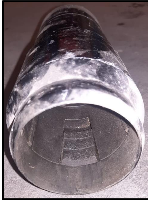
Figura 28. Core Catcher Orientador con posición de las lengüetas para la extracción.
