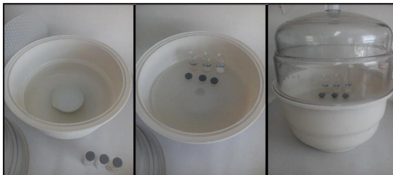
Figura 2. 12. Sistema empleado para la obtención de las isothermas de adsorción-desorción de agua a 20°C.
