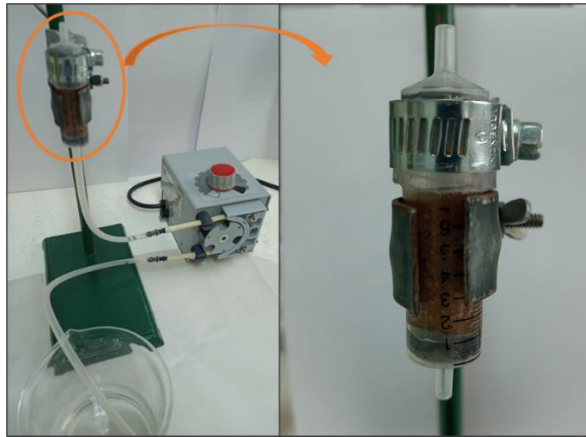
Figura 3. 17. Imagen del sistema semicontinuo y columna rellena.
