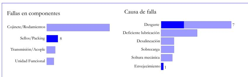
Figura 31. Identificación de las causas de fallas en sellos mecánicos.
