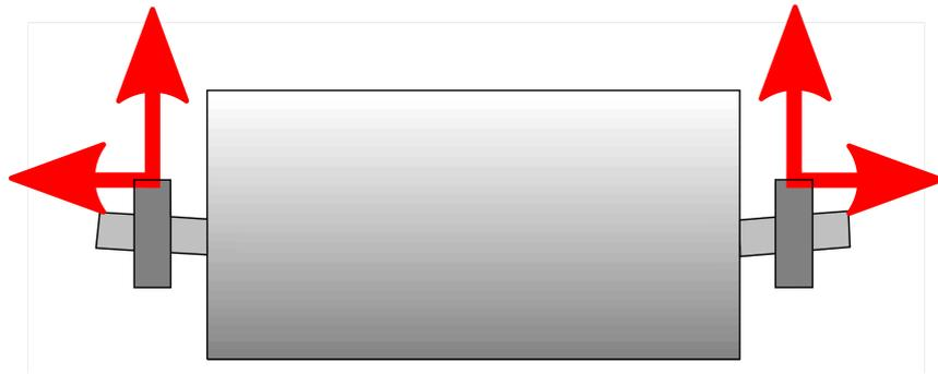
Figura 13. Eje doblado o flexionado (White, 2010).
