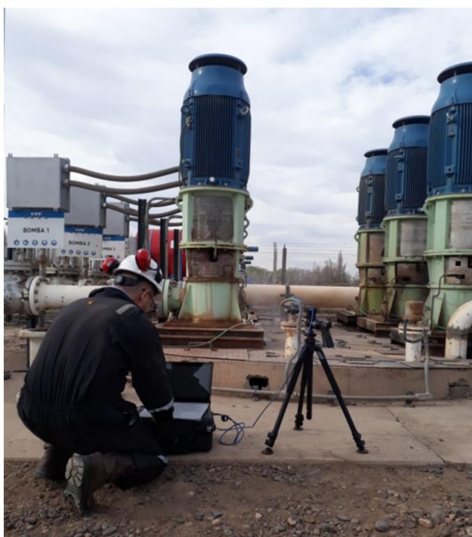
Figura 56. Inspección con cámara de amplificación de movimiento.
