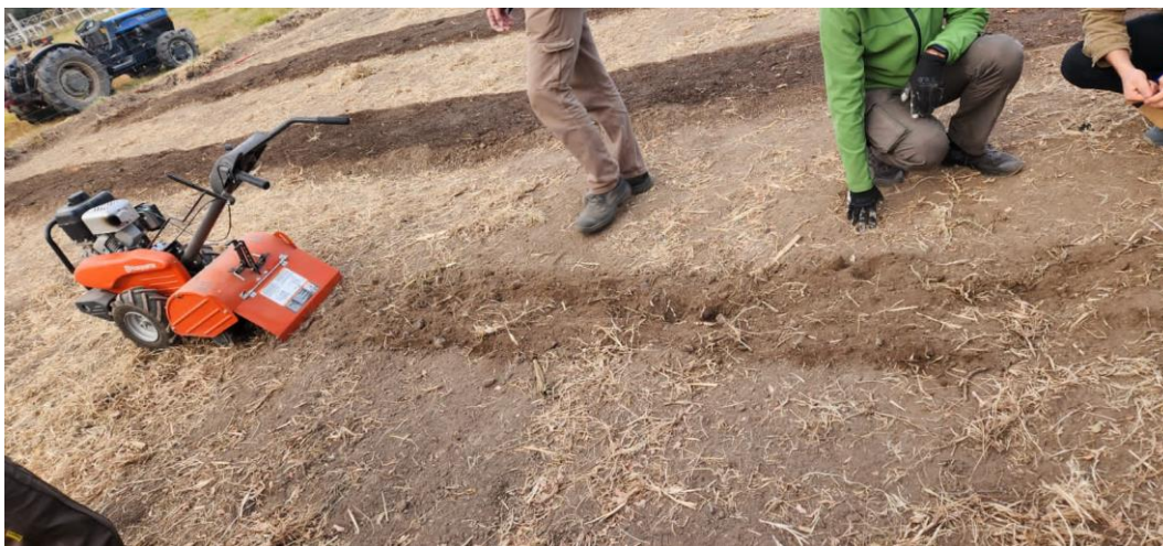
Figura 5. Motocultivador utilizado en la desestructuración de la costra formada por el riego.
