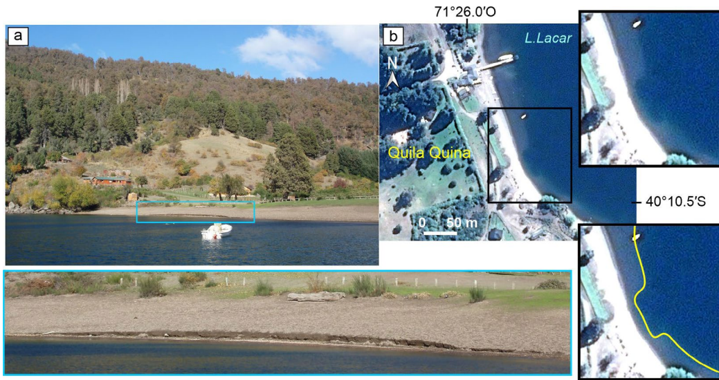
Figura 11. a) Fotografía obtenida durante una salida de campo en mayo 2015, donde se observa claramente la escarpa de cabecera del movimiento en masa ocurrido en el delta del río Grande (Quila Quina) en marzo 2015; b) Imagen satelital (Google Earth) obtenida en julio 2016. La ubicación del veril (en amarillo) muestra la extensión de la escarpa de cabecera del deslizamiento subacuático.
