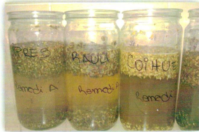
Foto N° 3: semillas sometidas a test de flotación.
