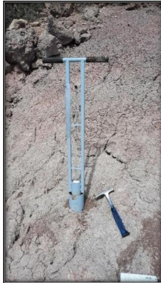
Figura 26: infiltrómetro de doble anillo.
