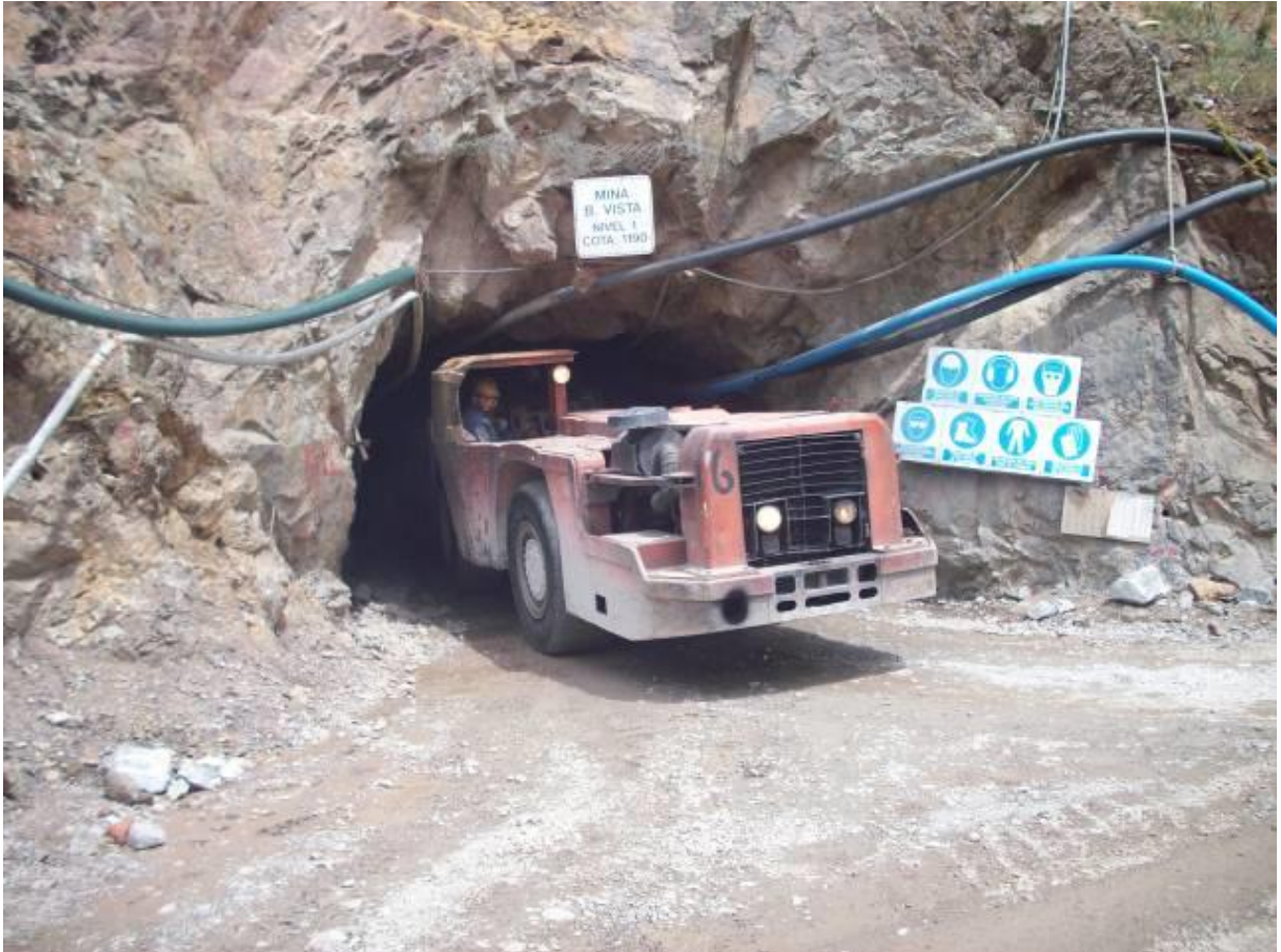
Equipo de carguío y transporte de mineral en la bocamina de la mina Buena Vista nivel I en el yacimiento Andacollo, Neuquén.
