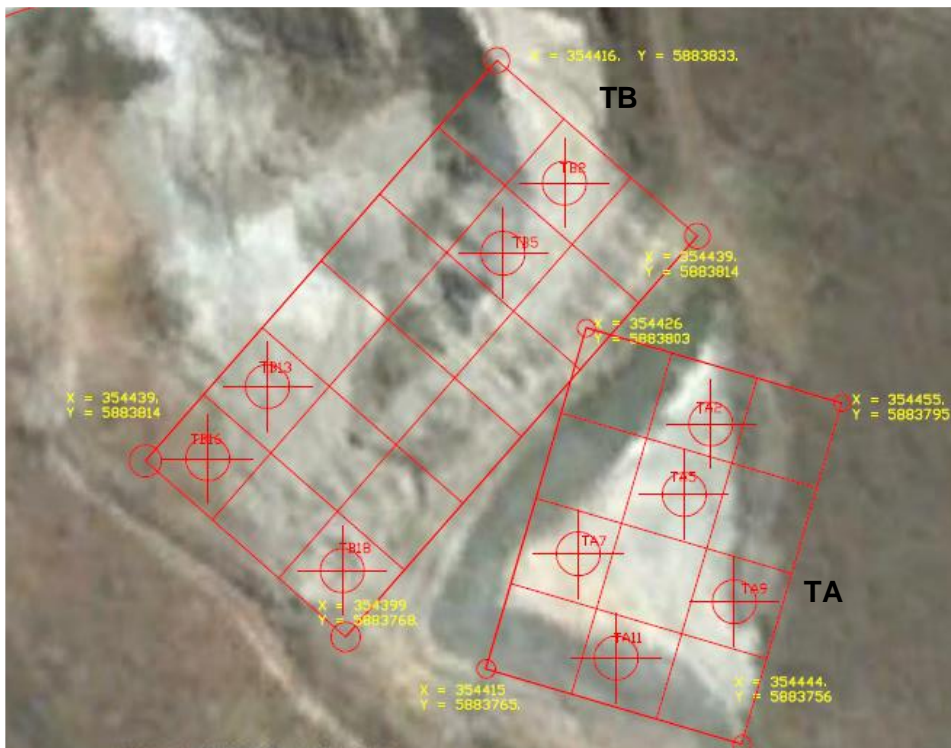
Figura 11. Sitios de muestreo sobre los taludes A (derecha) y talud B (izquierda)
