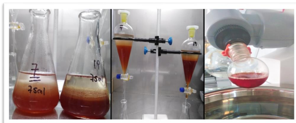
Figura 35: Mezcla de extractos acuosos con acetato de etilo (izquierda), separación de fases en campana de decantación (medio) y secado de extracto en rotavapor (derecha).
