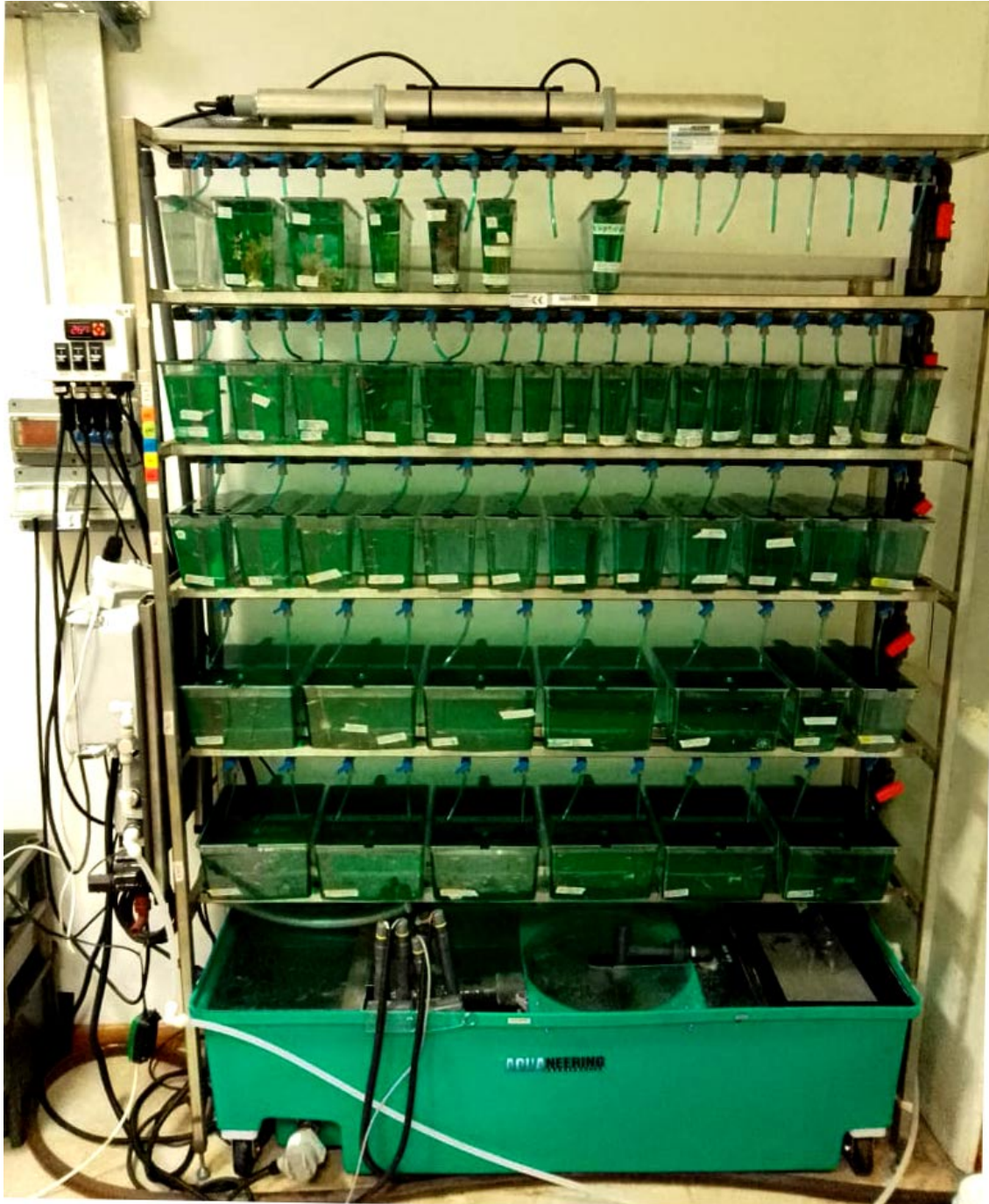
Figura 6.1: Sistema de recirculación de agua utilizado para la cría de pez cebra ( Danio rerio ). ZS560, Aquaneering, San Diego, CA.
