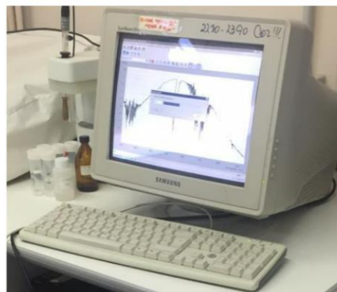
Figura 17 Equipo de FTIR INFRALUM FT-08.
