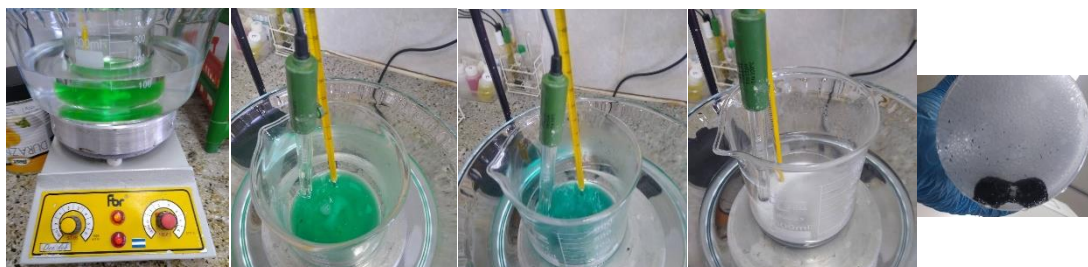
Figura 11 Tratamiento del efluente residual: Precipitación por óxido-reducción. De izquierda a derecha: Residuo de Ni; Ni- \text{N}_2\text{H}_4 ; \text{Ni}(\text{OH})_2 ; precipitan las partículas de níquel; y finalización de la síntesis.
