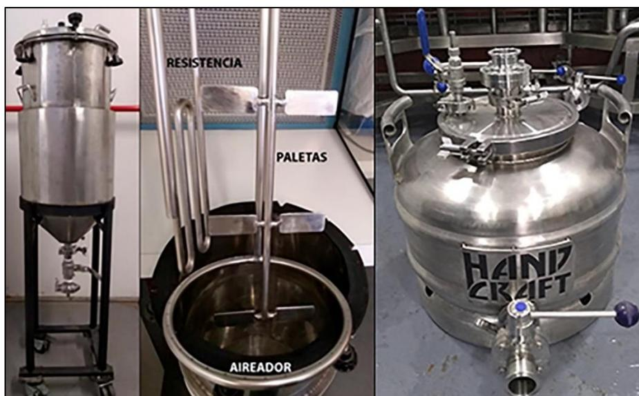
**Figura 3.3.** A la izquierda, propagador utilizado para el escalado y obtención de biomasa de *S. eubayanus*. En el medio, piezas internas del propagador. A la derecha, cosechador para la conservación y el traslado de la biomasa.
