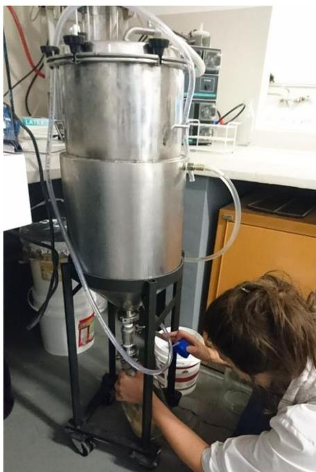
**Figura 3.12.** Toma de muestra del propagador cilindro-cónico para análisis de la biomasa.
