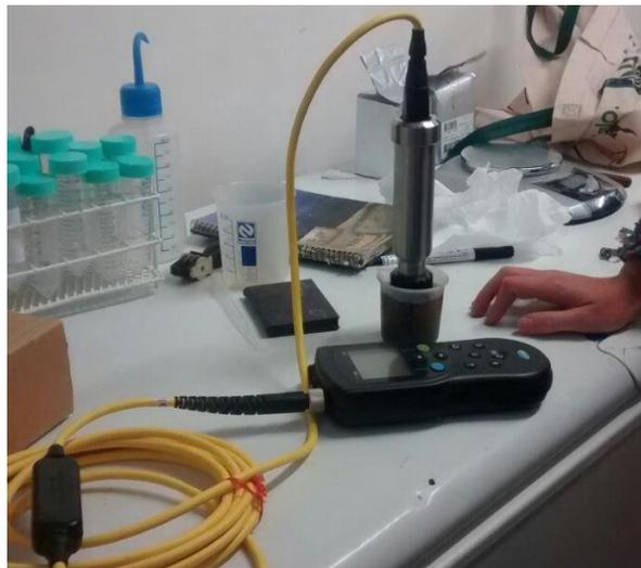
**Figura 5.2.** Medición de oxígeno disuelto (ppm) en los mostos oxigenados ensayados.
