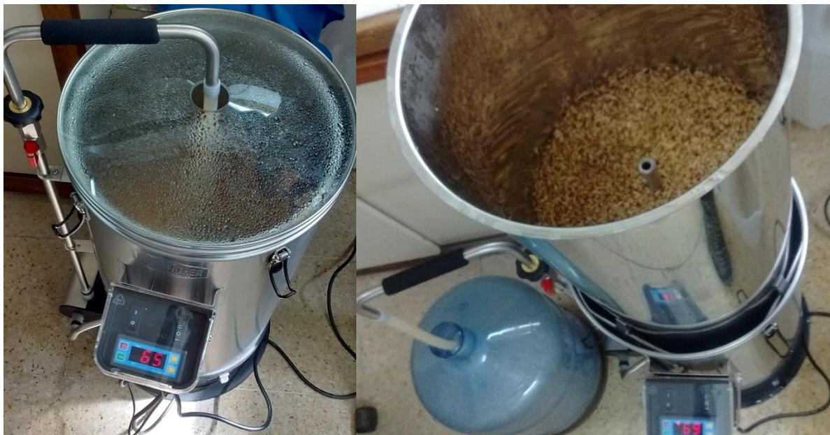
**Figura A.** A la izquierda, equipo automático Robobrew All Grain en proceso de maceración. A la derecha, filtrado de granos y recolección de mosto en bidón de 20 L para su posterior esterilización.
