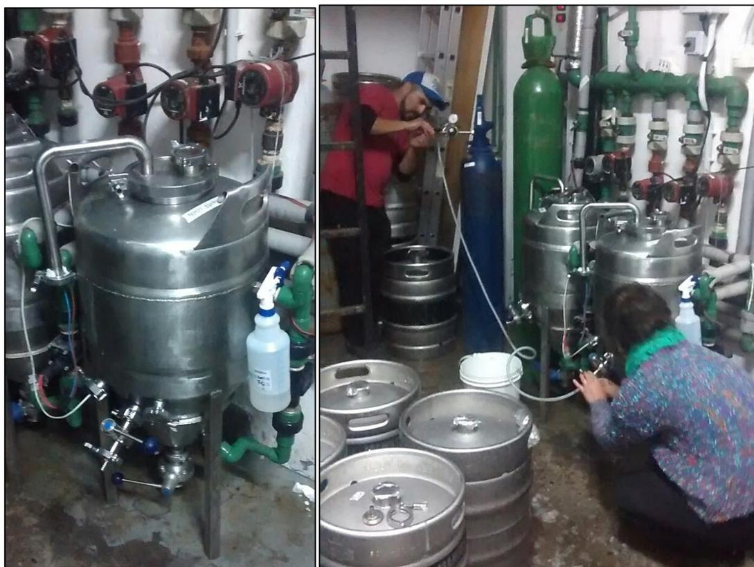
**Figura 5.1.** Fermentador cilindro-cónico utilizado en las fermentaciones a escala semi-piloto.
