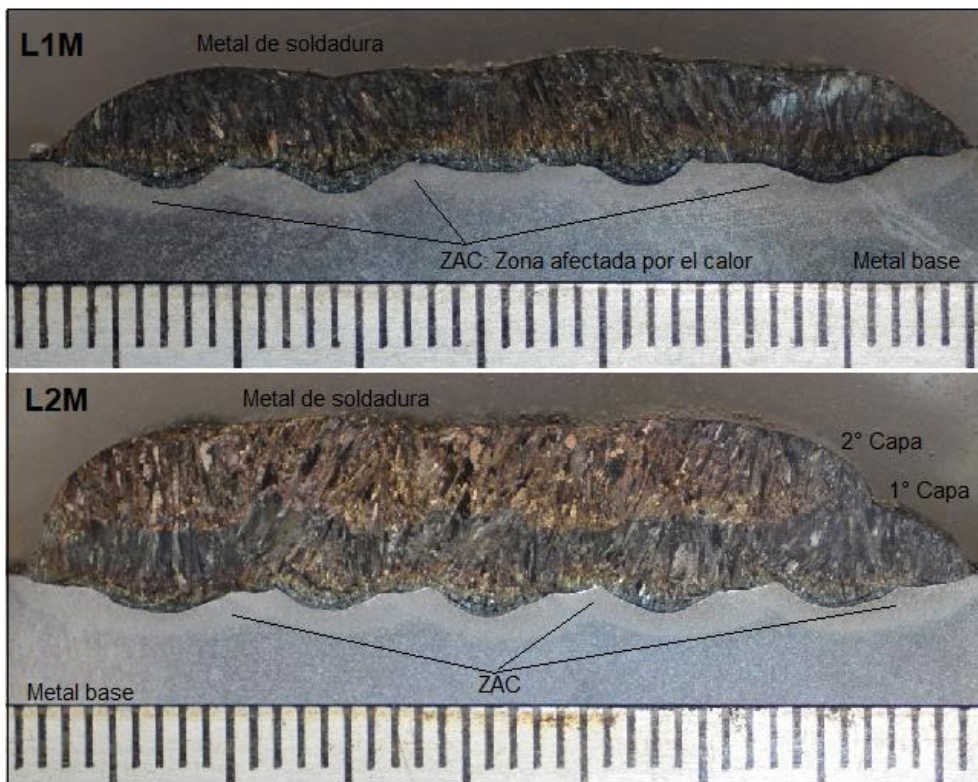
Figura 38. Macrografías de las probetas transversales L1M y L2M.
