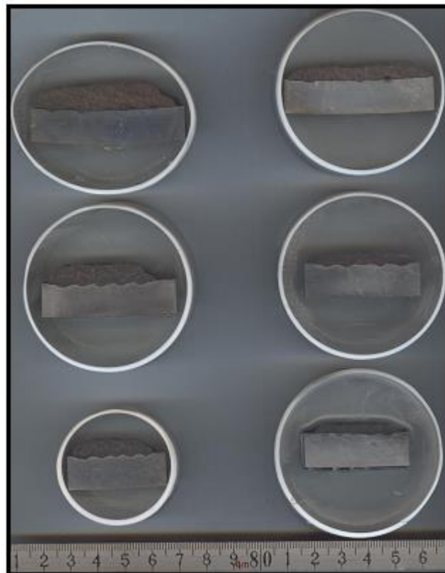
Figura 25. Muestras transversales de soldadura de recargue con metal de aporte LDSS.
