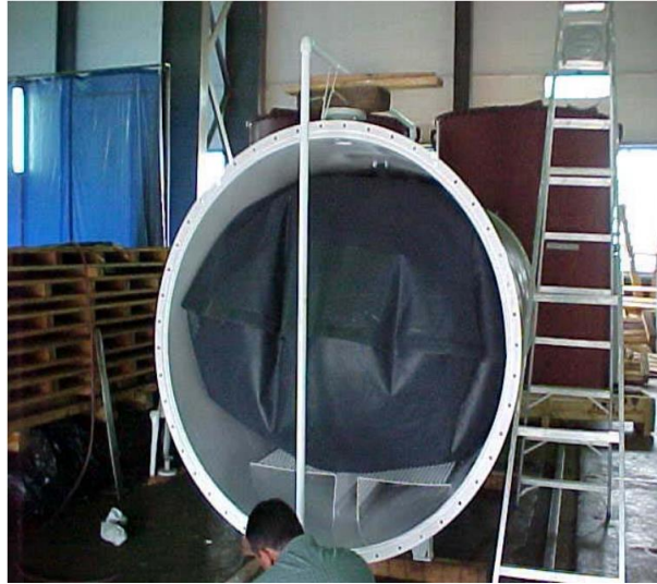
Figura 1.17-Balón de caucho para sistema de preservación de aceite tipo sellado.
