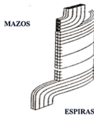
Figura 5.5-Bobinado cilíndrico de 1 capa.
