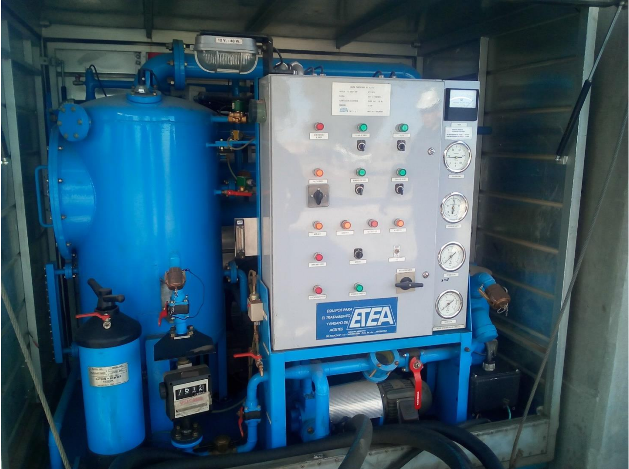
Figura 3.5-Equipo purificador de aceite de hasta 2500 litros/ hora marca ETEA.
