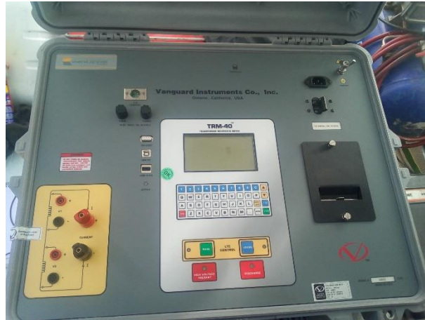
Figura 3.6-Equipo Vanguard Instruments & Co. modelo TRM-40 para medición de resistencia de arrollamientos.
