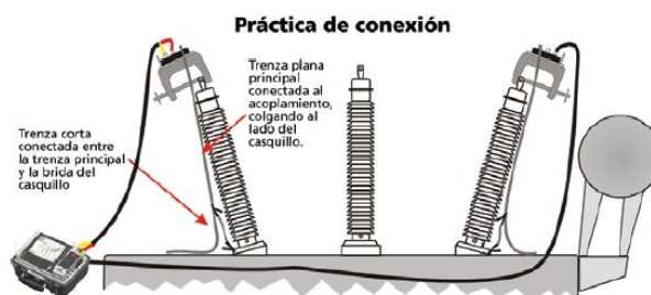
Figura 2.13-Esquema de conexión para ensayo FRA.
