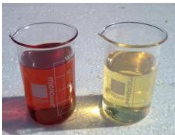
Figura 3.15-Apariencia del aceite antes y después de su regeneración.
