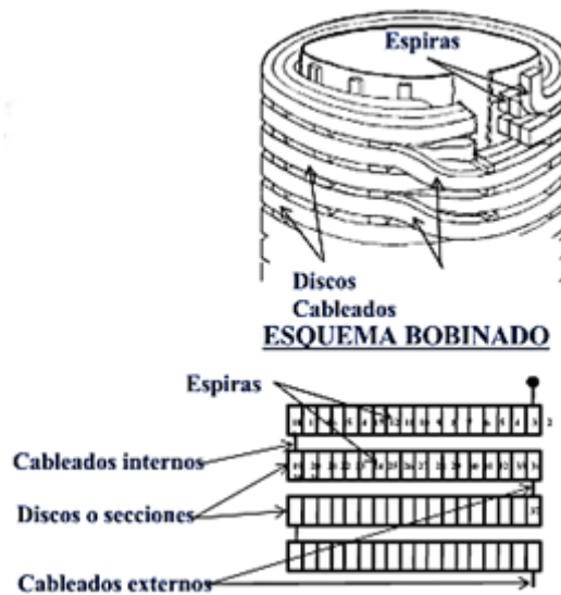
Figura 5.9-Bobinado de disco tipo continuo.
