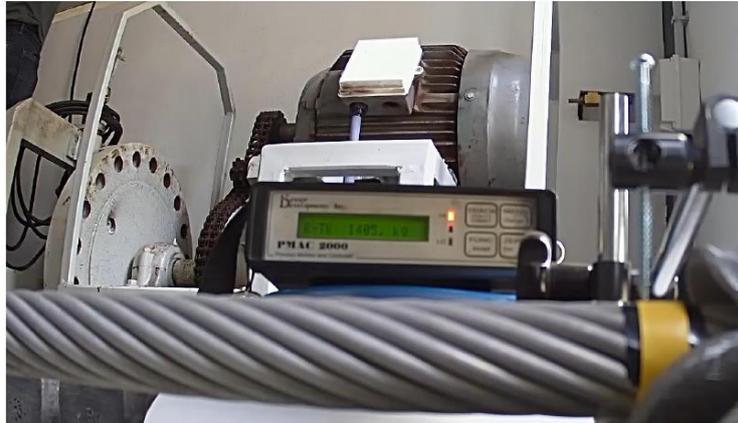
Figura 6 - Muestra 2 inicio de deslizamiento
