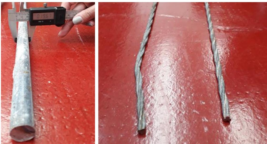
En el extremo superior de la columna que se encontraba entera (C7) se observó únicamente 20 cordones de pretensado. En las columnas restantes, en las secciones de rotura, se observó los 20 cordones de pretensado y 5 barras de refuerzo de diámetro 20 mm.
