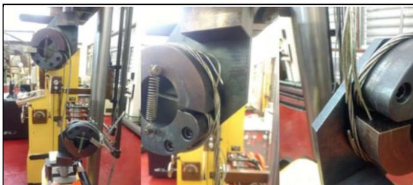
También se ensayaron hilos individuales tanto del alma de acero como de los conductores de aluminio en un equipo INSTRON – EMIC 23-30. Para el montaje de los hilos en el marco de carga se utilizó también un dispositivo tipo cabrestante que trabaja por principio de freno de prony (“UNCO D200 mm”).
