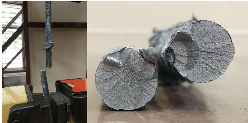
Figura 2: Probeta ensayada y detalle de la fractura.
