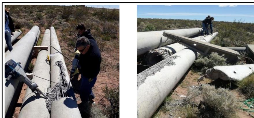
Las columnas mantienen los 20 cordones de pretensado en toda su longitud (armadura tesa). En cuanto a la armadura longitudinal convencional, ésta se va incrementando desde la cima a la base de acuerdo a la siguiente distribución (Fig. 53):
