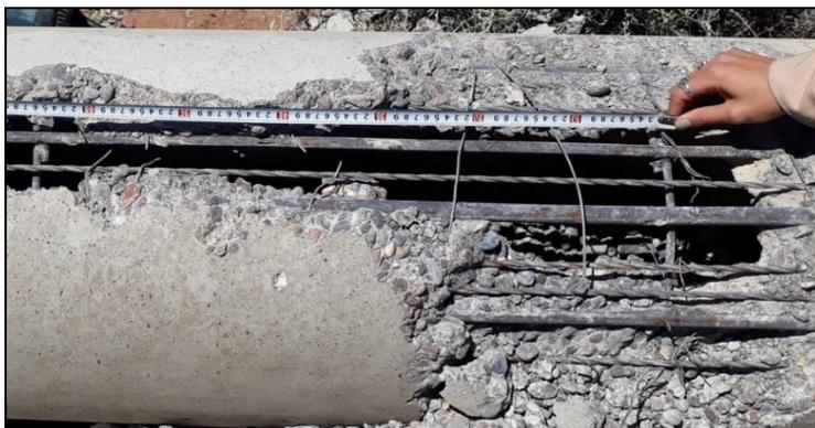
Por último, se realizó la toma de muestras de los materiales componentes de las columnas con el objetivo de ensayarlos posteriormente en el laboratorio. Se ejecutó la extracción de tres testigos de hormigón en ubicaciones y columnas distintas, y se extrajo muestras de las barras que integran la armadura de refuerzo y de los cordones pretensados.
