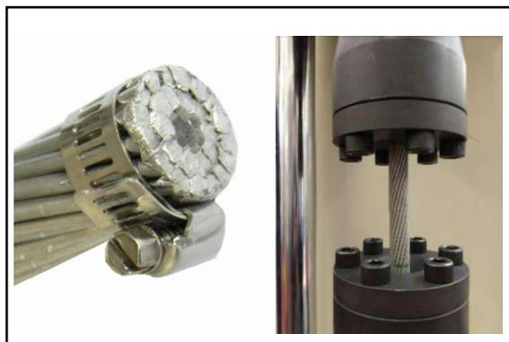
Se ensayaron 2 probetas del alma completa en la Máquina Universal Wolpert en escala de 100 kN (Fig. 61). Para la sujeción de las muestras a la máquina se utilizó un sistema de construcción propio, tipo cabrestante, que trabaja por el principio de freno de prony.
