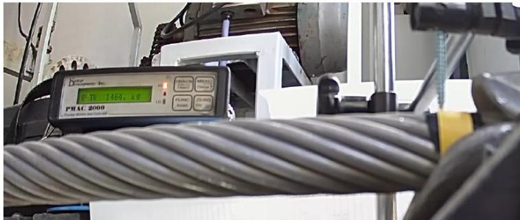
**Figura 4 - Muestra 1 inicio de deslizamiento**
