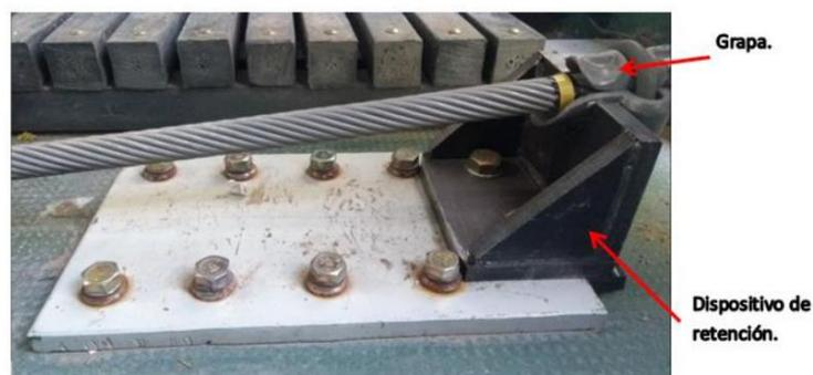
Figura 1 - Sistema de retención
