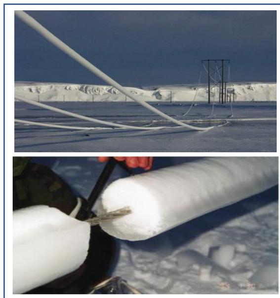
Al especificar las cargas se realizan algunas simplificaciones, por ejemplo, la densidad de acreción, que es variable en el espesor debido a la compactación que genera la propia acumulación, se supone constante, y el espesor del hielo de diseño se especifica como un espesor radial uniforme equivalente a lo largo del cable a pesar que las acumulaciones pueden tener formas irregulares.
