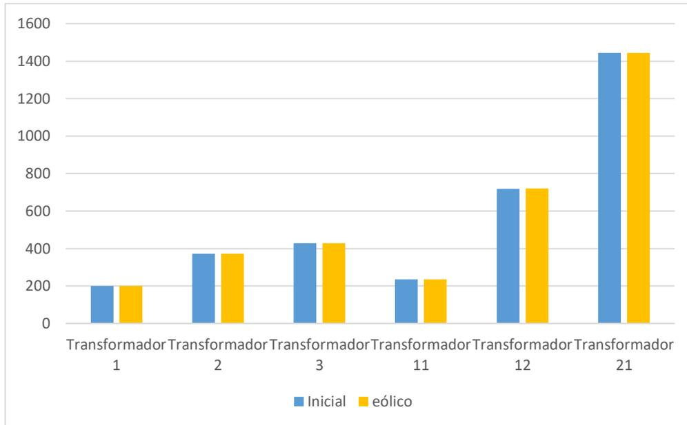
Figura 86. Pérdida de potencia activa en los transformadores con sistema eólico 1 [W].
