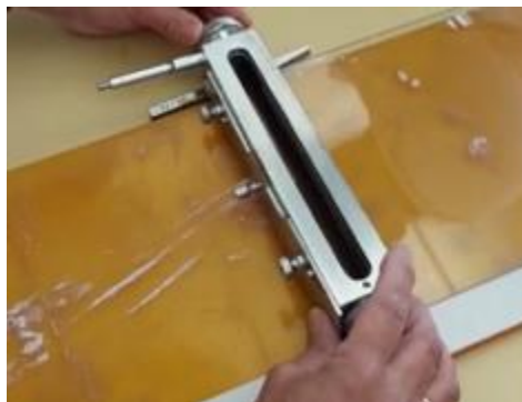
Figura 2-6: Equipo de extensión cromatográfica.
