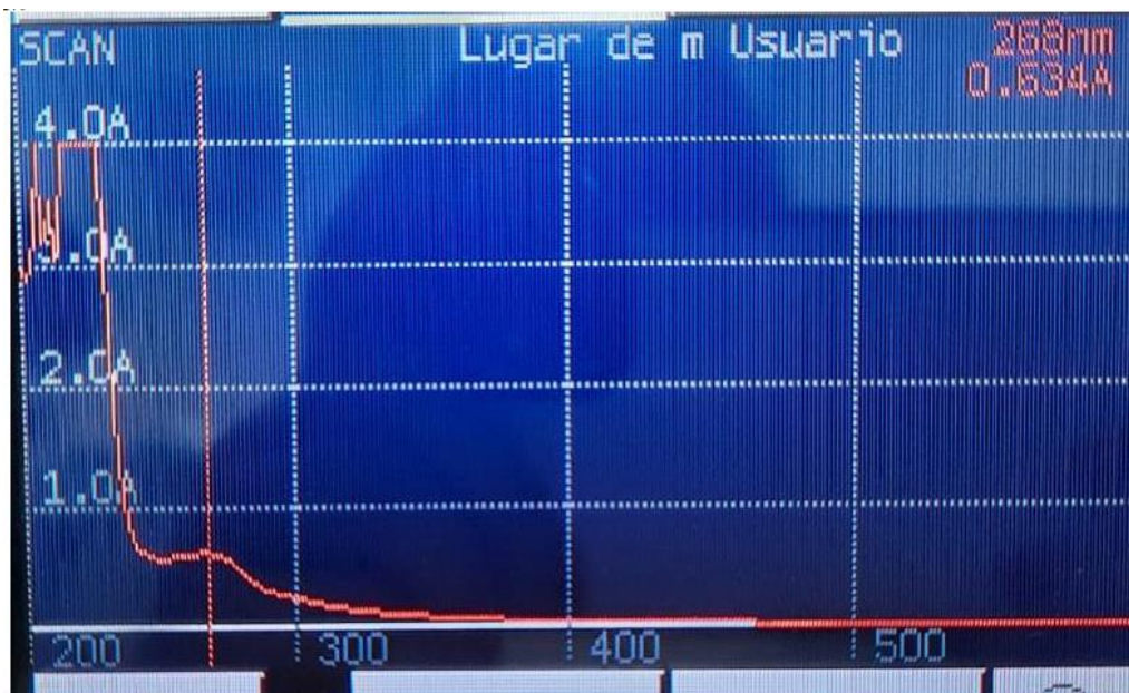
Figura 3-19: Espectro de absorción del sobrenadante de la muestra con coagulante.
