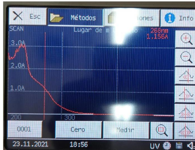
Figura 3-24: Espectro de absorción de la muestra con 0,3 mL/L de H_2O_2 y sulfato cúprico.
