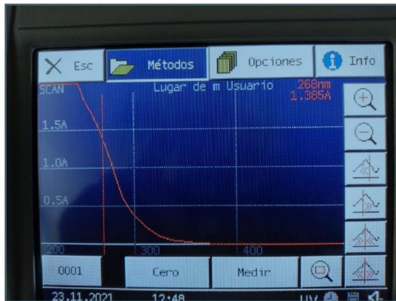
Figura 3-23: Espectro de absorción de la muestra con 0,5 mL/L de H_2O_2 y sulfato cúprico.
