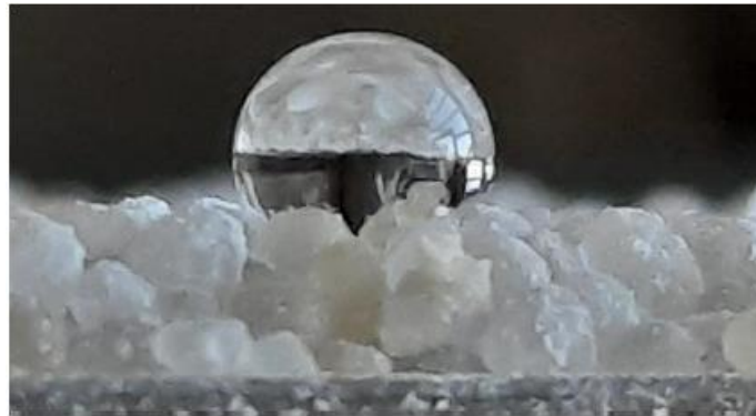
Figura 3-8: Gota de agua sobre los granos de una arena 16-30 modificada con Silquest 172 E.
