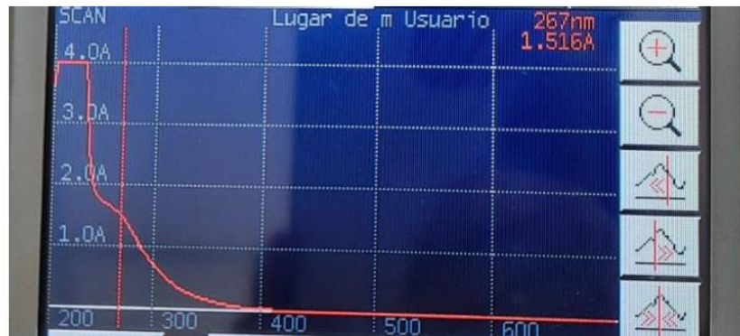
Figura 3-22: Espectro de absorbancia de la muestra tratada con Fenton, a pH 7.
