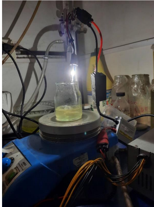
Figura 2-20: Equipo utilizado para ensayo foto-fenton.
