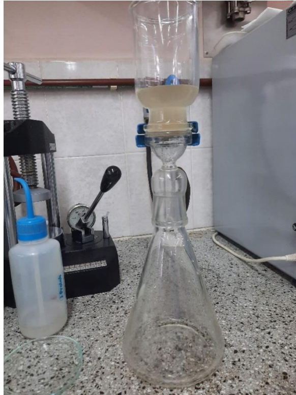
Figura 2-7: Equipo de filtración.
