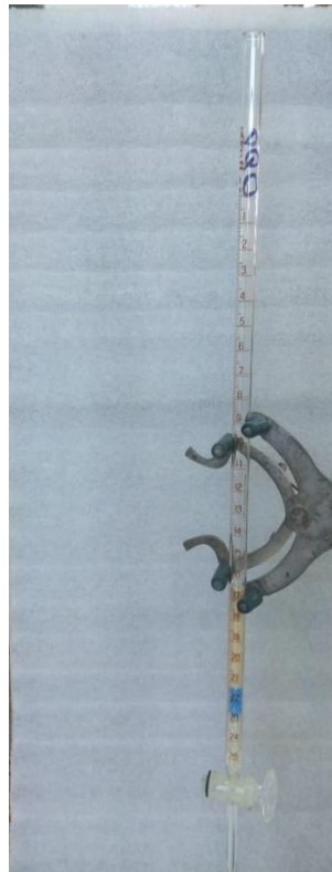
Figura 2-17: Columna montada con arena 16/30 modificada con el reactivo A-172 E.
