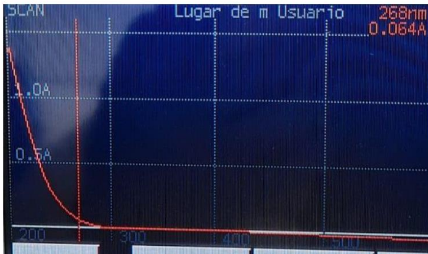
Figura 3-20: Espectro de absorción de agua destilada y peróxido de hidrógeno a 1ml/L.
