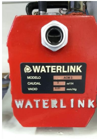
Figura 2-8: Bomba de equipo de filtración.
