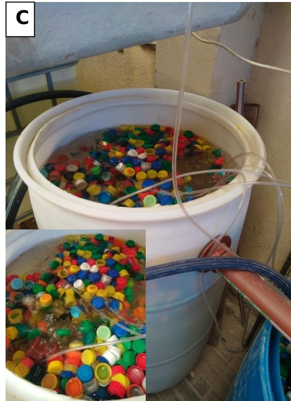
Figura 15. A) Biofiltro con contenedor de 70L. y sustrato tipo K1 B) Biofiltro con contenedor de 200L. y sustrato tipo K1; C) Biofiltro con contenedor de 200L. y sustrato de tapas plásticas.
