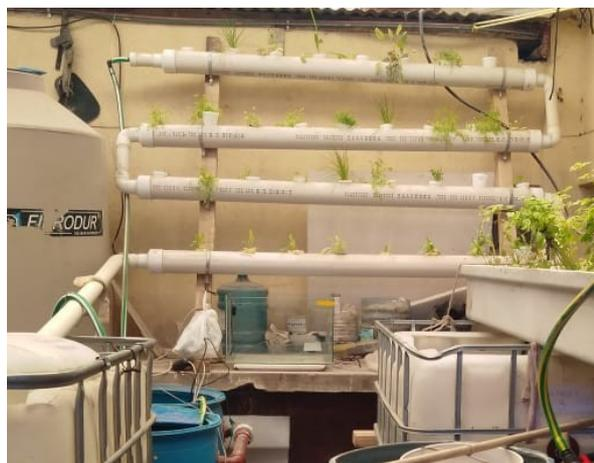
Figura 17. Sistema NFT instalado en CIMAS, San Antonio Oeste, Río Negro.
