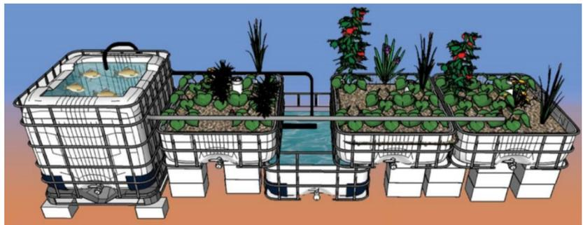
Figura 19. Sistema de lecho de sustrato / sustrato de cama sólido. Fuente: Somerville, 2014.
