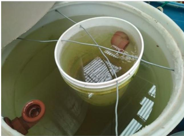
Figura 3. Filtro mecánico de sedimentación, confeccionado con materiales reciclados.
