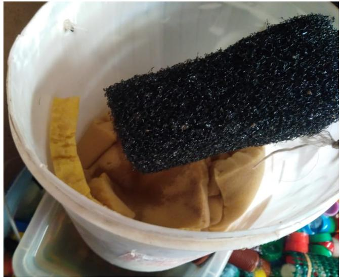
Figura 9. Filtro mecánico confeccionado con esponjas y materiales reciclados.
