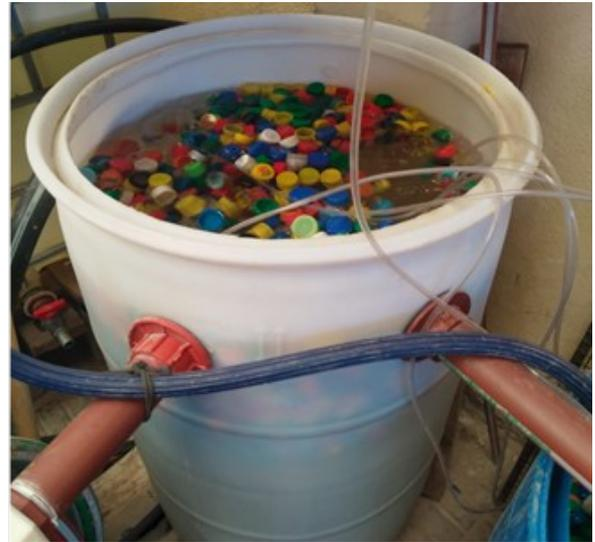
Figura 4. Biofiltro con tapas plásticas como medio de sustrato para las bacterias.
