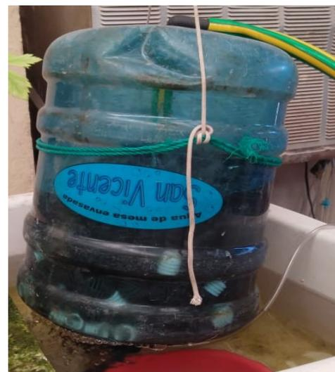
Figura 16. Filtro percolado confeccionado con taque de 20L y bigollas en su interior
