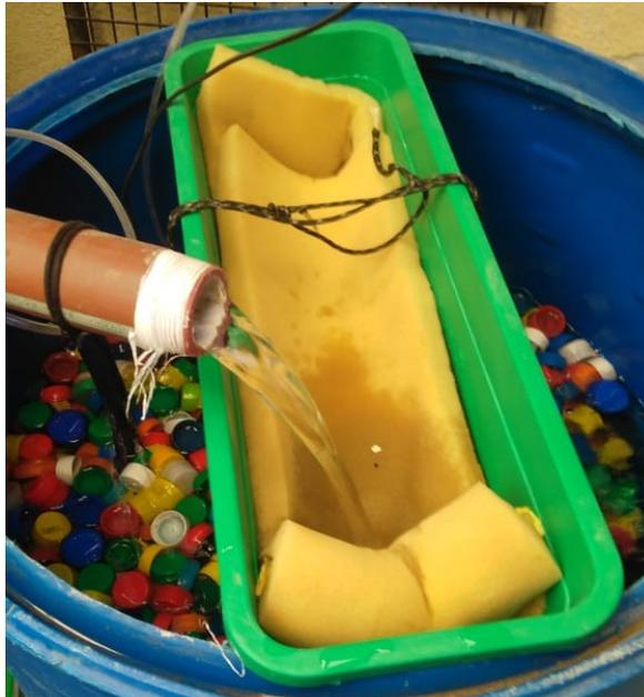
Figura 8. Filtro mecánico para retención de partículas finas de heces de pez y restos de alimento no consumido.
