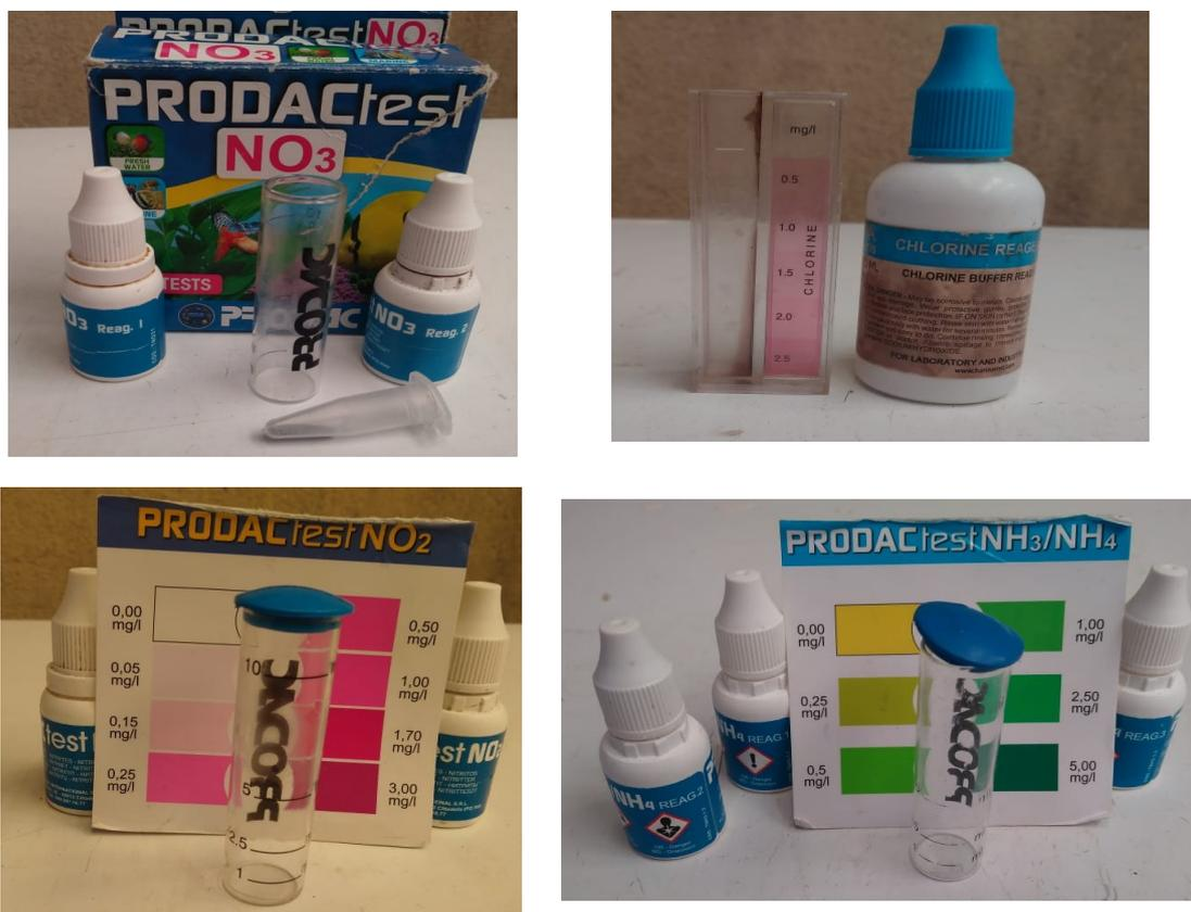
Figura 6. Kits colorimétricos para medición diversos parámetros.  $\text{NO}_3$ , cloro disuelto,  $\text{NO}_2$  y  $\text{NH}_3/\text{NH}_4$ .
