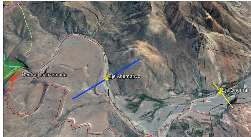
Figura 3-2. Alternativas posibles para el eje de cierre del Dique Compensador sobre el cauce del Río Neuquén. Fuente: Apartado 9- Documentos Técnicos.
