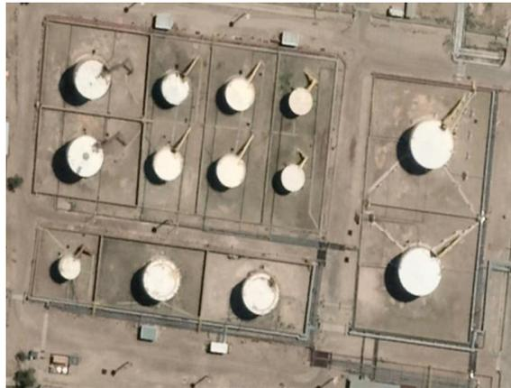
Figura 2.14: Batería de Tanques en recintos subdivididos.
