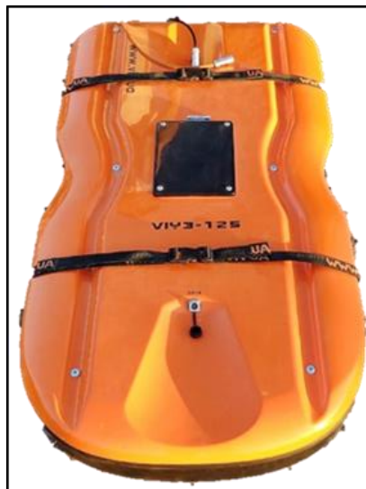
Figura 30: Antena monoestática VIY de 125 MHz.
