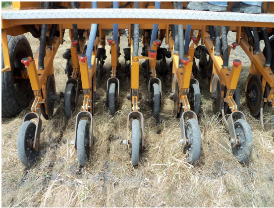
Fig. 9: Siembra de cebolla con cultivo de cobertura, utilizando una sembradora de siembra directa de doble disco con rueda limitante de profundidad trasera, de 11 hileras.
