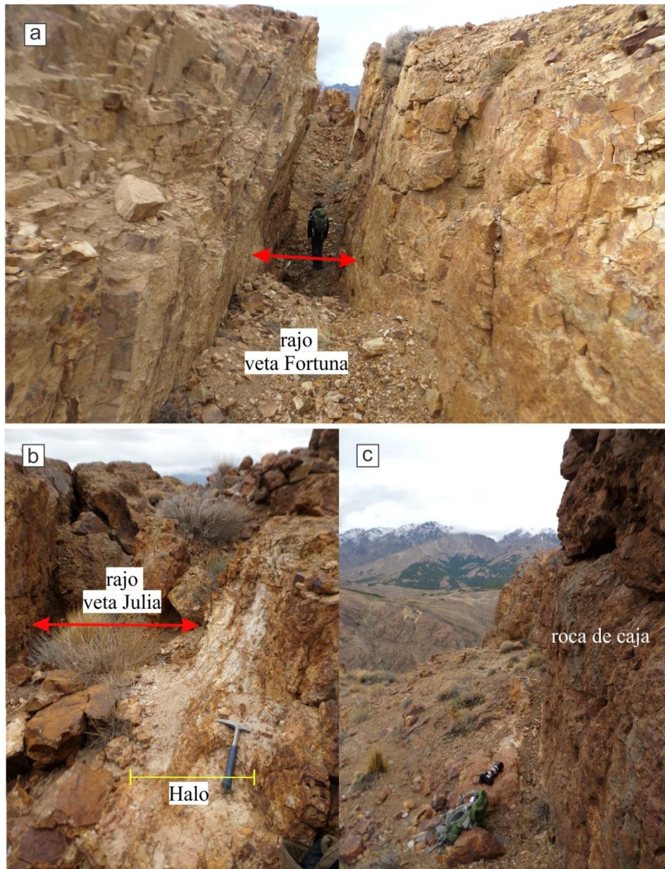
Figura 4.1. Fotografías de campo veta Julia y Fortuna. a) Afloramiento de rajo de veta Fortuna en ladera oeste del cerro Minas. b) Afloramiento de rajo de veta Julia y halo arcilloso de 30 cm de espesor. c) Las facies de arenisca sabulítica de la Formación Huaraco que hospedan a la veta Julia, con alteración sericítica intensa y boxwork de pirita, los óxidos e hidróxidos de hierro le confieren un color castaño rojizo al afloramiento (fotos Pons, 2017).
