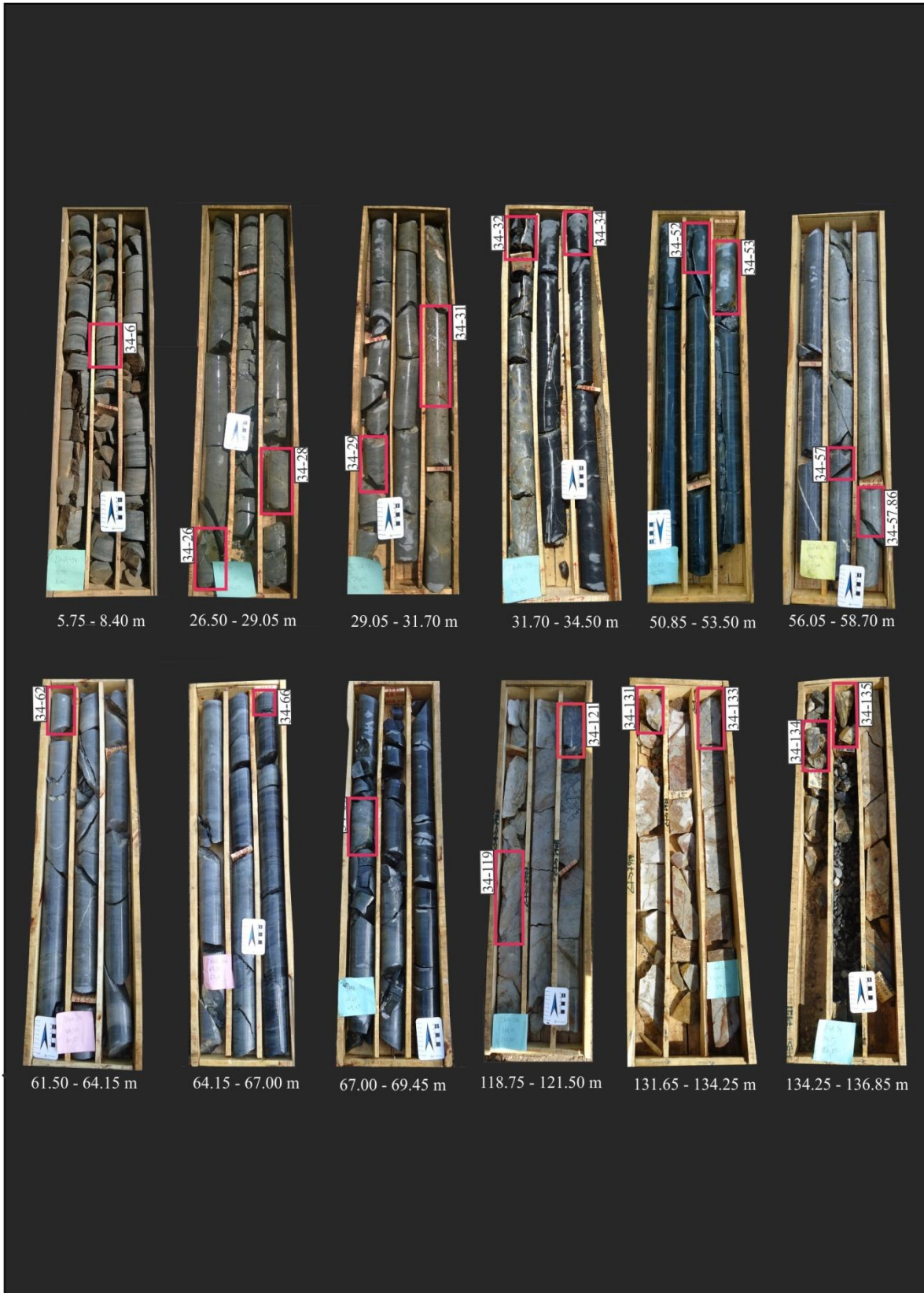
ANEXO A3. Muestras seleccionadas para la caracterización litológica, mineralógica y textural del sondeo DHA-34.
