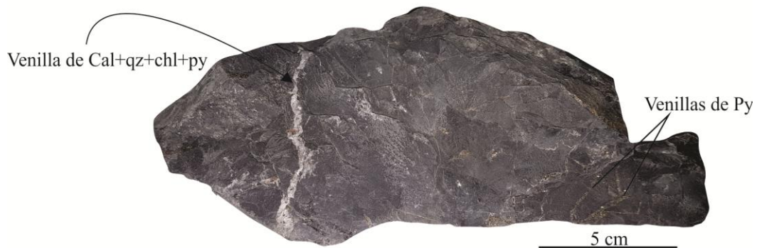
Figura 2.8. Muestra de mano representativa de la lutita de la F. Huaraco extraída de interior de galería Nivel 4. Se observan las venillas de Cal+Qz+Chl±Py y venillas de Py.
