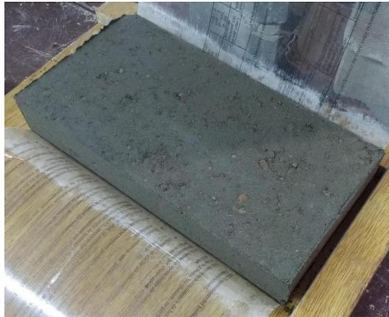
Figura 5.1: Foto de segregación de partículas por exceso de vibración.
