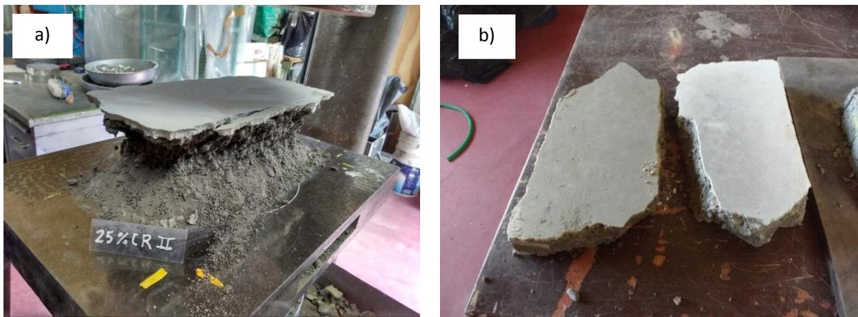
Figura 5.6: Fotos de rotura típica de bloque: a) Cumpliendo requisito normativo; b) Altura/Ancho < 0,5.
