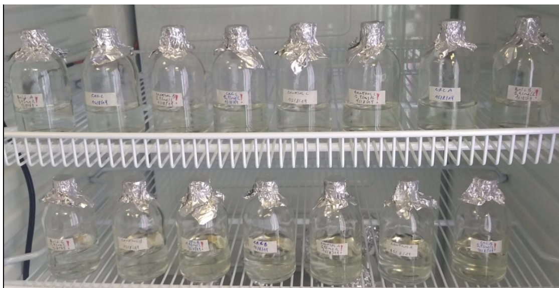
Figura 3.18. Imagen de la disposición de los viales en la incubadora durante el experimento. Esta foto es representativa de todos los ensayos realizados bajo condiciones experimentales similares: densidad celular inicial de 1 \times 10^5 células/mL; pH 6,8; fotoperíodo de 14 horas de luz y 10 hs de oscuridad; irradiancia de 80 \mu\text{mol fotón m}^{-2} \text{s}^{-1} ; volumen de 30 ó 40 mL; 3 réplicas por tratamiento.
