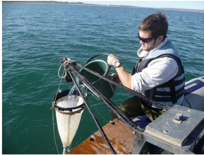
Figura 16: Filtrado de muestras de agua subsuperficial a través de redes Hydro-bios®.
