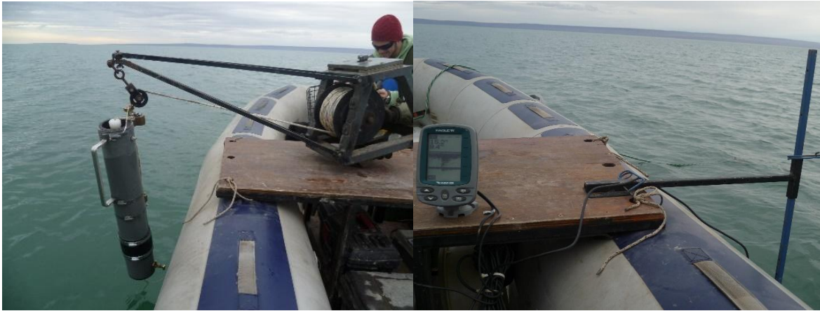
Figura 14: Botella Van Dorn para colección de muestras de agua (izquierda) y ecosonda Eagle Cuda 128 utilizada para determinar profundidades de sitios de muestreo en el embalse (derecha).
