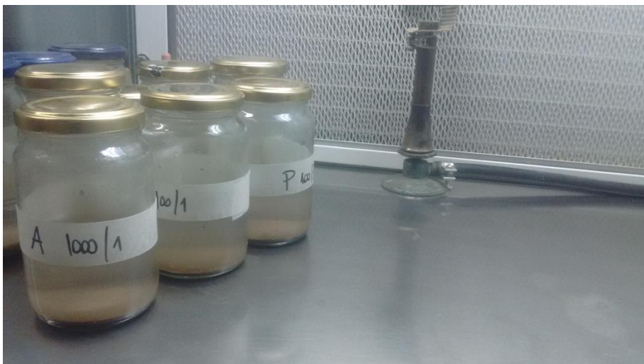
Figura 61: Reactores batch con sedimentos o suelos contaminados con HAPs y con agregado de los diferentes oxidantes.
