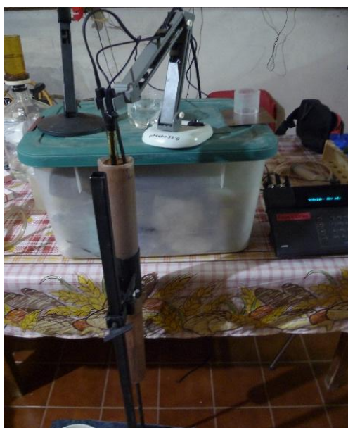
Figura 18: Mediciones de ORP, pH y temperatura en el campo, utilizando equipo Orion 920 A.
