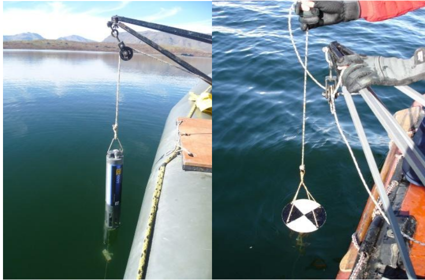
Figura 15: Sonda multiparamétrica Esy 6000 (izquierda) y disco de Secchi (derecha).
